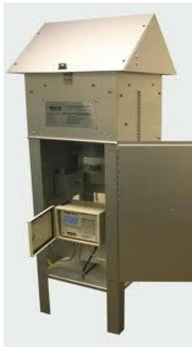
Figura 6. Muestreador de alto volumen (HI-VOL).
