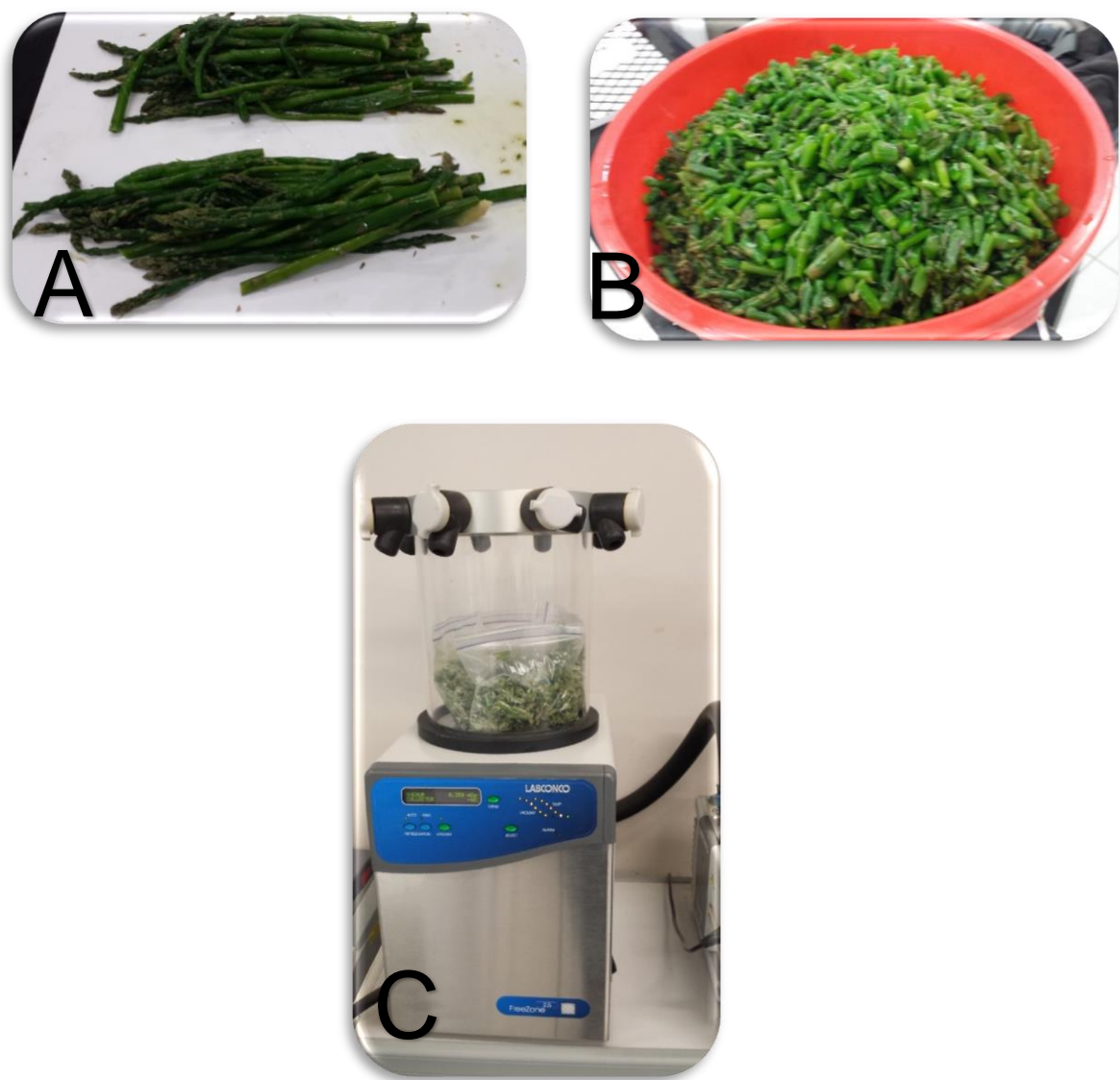
Figura 1. (A) Espárrago utilizado como materia vegetal, (B) Espárrago cortado en trozos pequeños, (C) Se muestra espárrago en proceso de liofilización
