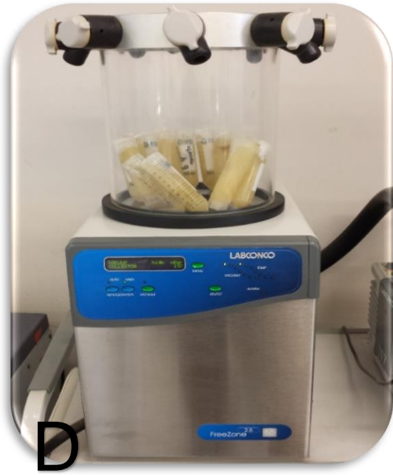
Figura 2. (A) Espárrago liofilizado y macerado, (B) mezcla filtrada del polvo de espárrago con metanol, etanol y agua destilada, (C) equipo evaporador rotario para la recuperación del concentrado, (D) tubos falcón con el filtrado acuoso en el liofilizador LABCONCO.
