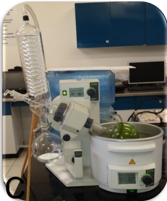
Figura 2. (A) Espárrago liofilizado y macerado, (B) mezcla filtrada del polvo de espárrago con metanol, etanol y agua destilada, (C) equipo evaporador rotario para la recuperación del concentrado, (D) tubos falcón con el filtrado acuoso en el liofilizador LABCONCO.
