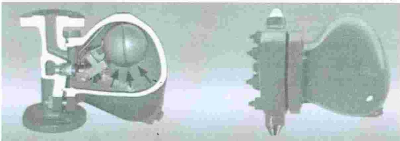
Figura 6.5. Ilustración de una trampa de vapor convencional (El vapor hace que el flotador cierre la válvula, el líquido eleva al flotador para después ser fugado, existen diferentes tipos de trampas de vapor)
