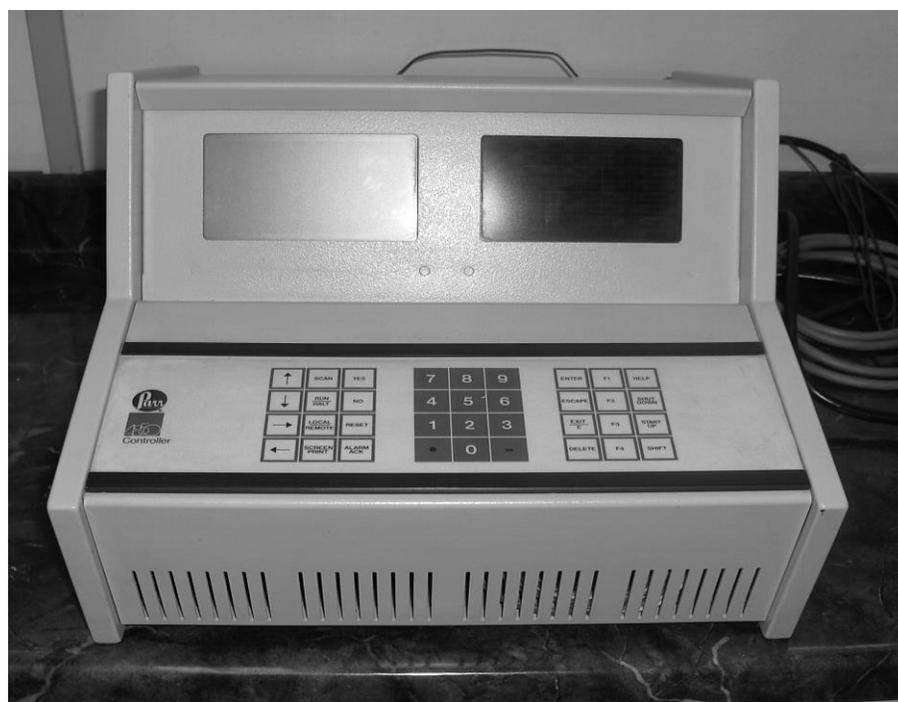
Figura 3.5. Controlador Modelo 4850 del Reactor Parr.
