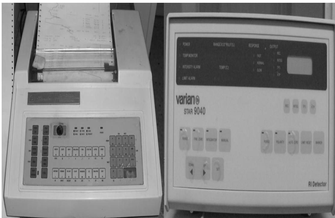
Figura 3.8. Integrador Shimadzu Chromatopac C-R3A y Detector IR Varian Star 9040
