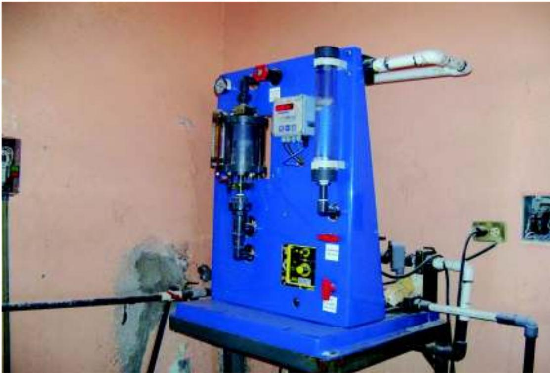
Figura 23. Equipo utilizado en la aplicación de desinfectantes del agua.
