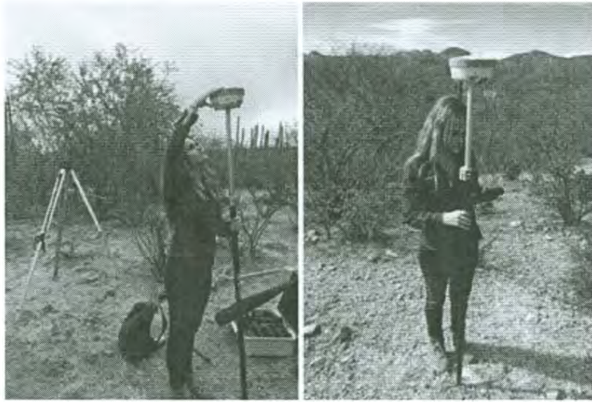
Figura 17. Instalación y configuración del móvil con una altura apropiada de acuerdo a la vegetación del sitio.
