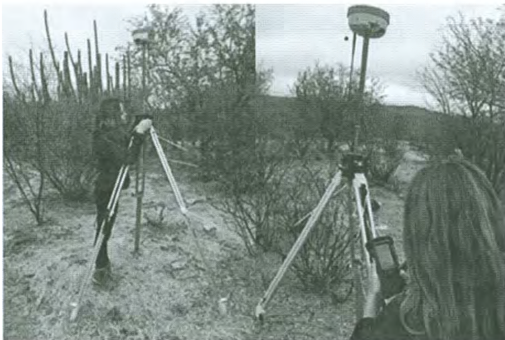
Figura 16. Instalación y configuración de la base de GPS Zenith 20
