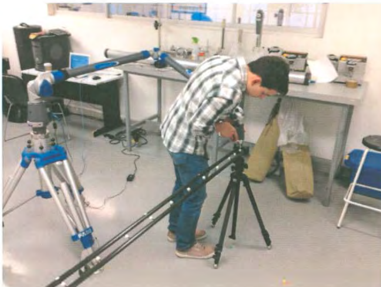
Figura 3.3.7 Barra colocada horizontalmente con trípodes en su mínima abertura.
