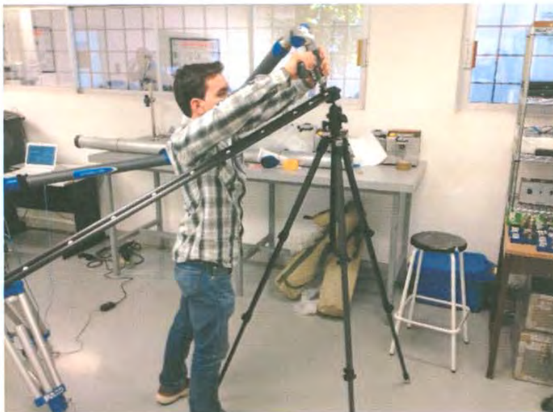
Figura 3.3.11 Barra colocada a 45^\circ , siendo la esfera 1 la que se encuentra en el extremo de mayor altura.
