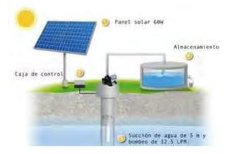
Ilustración 92. "Rebombeo solar". Fuente: solarmax.com
