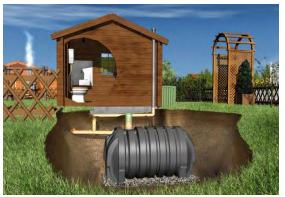
Ilustración 94."Fosa séptica". Fuente: desatascos.es/vaciado-y-limpieza-de-fosa-séptica
