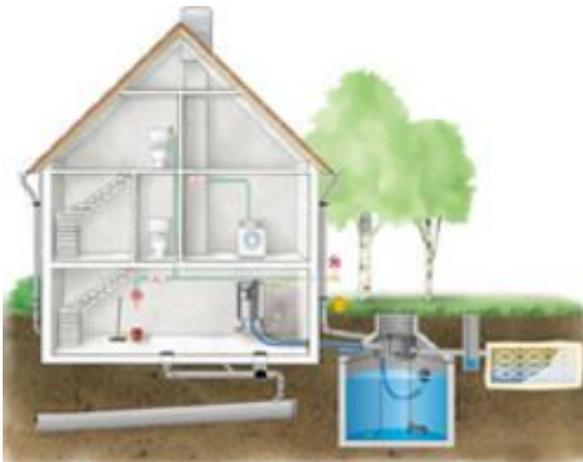
**Esquema 6.** Captación de agua de lluvia. S/E
