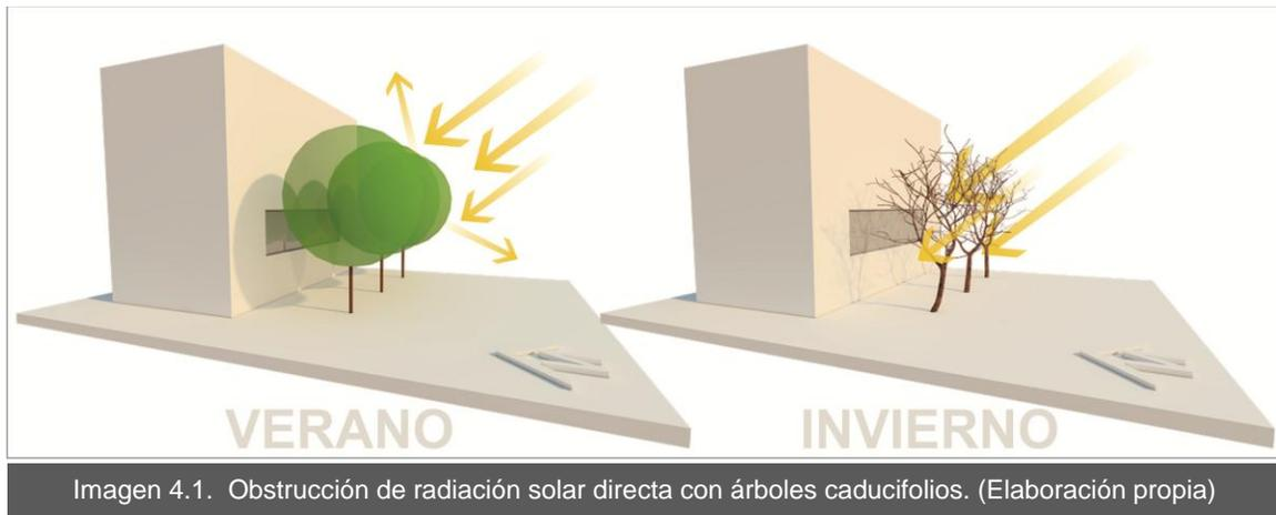
2. Utilizar elementos constructivos o vegetales que provoquen sombra para proteger los muros y ventanas del edificio, especialmente en las fachadas sur y oeste.
