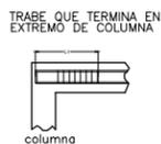
Colocar estribos del #3 en la longitud L1 a una separacion maxima de 10cms
