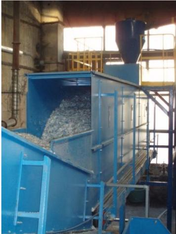
Imagen II.1.8 Closet de almacenamiento horizontal de película para cinta transportadora
