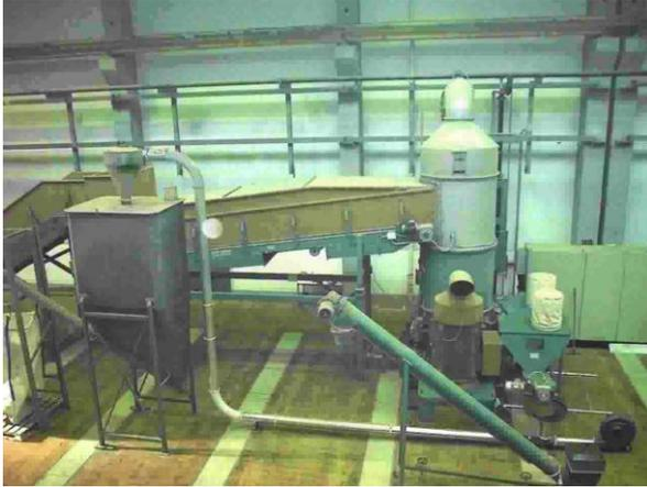
Imagen II.1.14 Sistema automático, densificador
