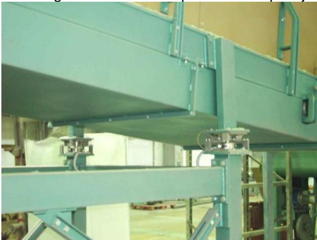
Imagen II.9 Celda transportadora de pesaje de correas
