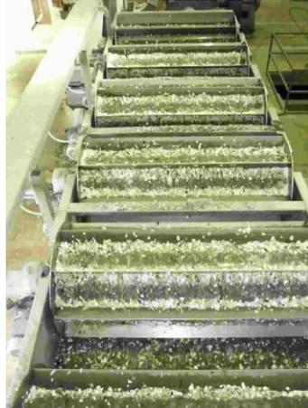
Imagen II.1.6 Deposito de lavado flotador / tanque de separación
