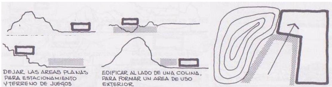
**Fig. 2.1.** Ubicación y posición de un edificio en terreno accidentado. S/E
