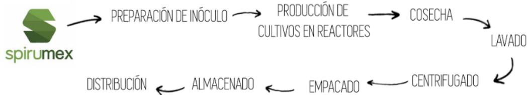
*Diagrama 1. Método de trabajo del funcionamiento de la empresa SPIRUMEX para el cultivo y distribución de la spirulina fresca. Fuente: Elaboración propia con información de Empresa SPIRUMEX.*
