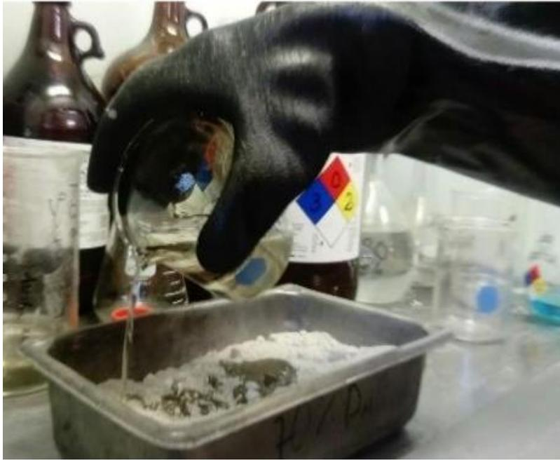
Figura 7. Fotografía representativa de la mezcla que se utilizó para la formación de pellets, la cual se obtuvo agregando jales secos y ácido sulfúrico concentrado.
