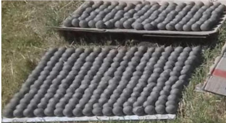
Figura 13. Fotografía de los pellets formados con una mezcla del 3% de bentonita y solución colas como aglomerante en proceso de secado a temperatura ambiente para su posterior uso en la prueba de columnas.
