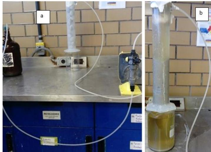
Figura 20. Representación esquemática de la prueba de columna a nivel laboratorio en donde podemos observar en la Figura (a) la representación esquemática simulando las columnas y el bombeo, al igual que la solución cabeza, por otro lado en la Figura (b) se muestra la probeta ya tapada y a punto de desbordarse.
