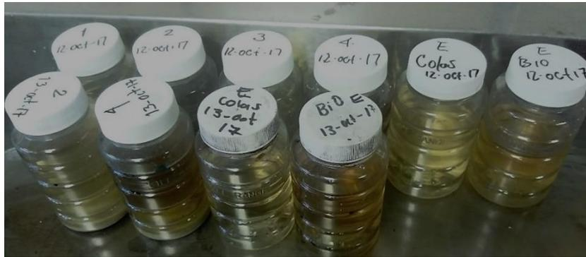
Figura 19. Muestras tomadas de solución lixiviada en las pruebas de las cuatro columnas, las cuales se etiquetaron de acuerdo al día en el que fueron muestreadas.
