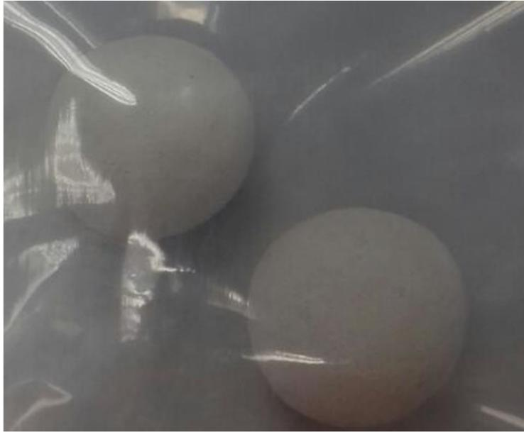
Figura 6. Representación de los pellets ya secos formados con la humedad propia de los jales.
