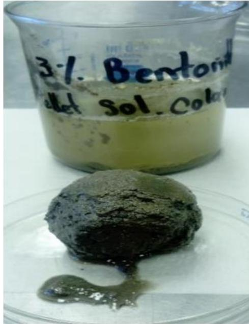
Figura 12. Fotografía tomada después de terminar con la prueba de permeabilidad, en donde se observa el único pellet que no se desintegro por completo, el cual está compuesto por 3% de Bentonita y solución colas como aglomerante.
