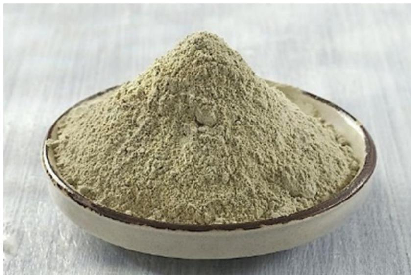
Figura 5. Fotografía de la bentonita utilizada para aglomerar, proporcionada de la misma empresa minera.
