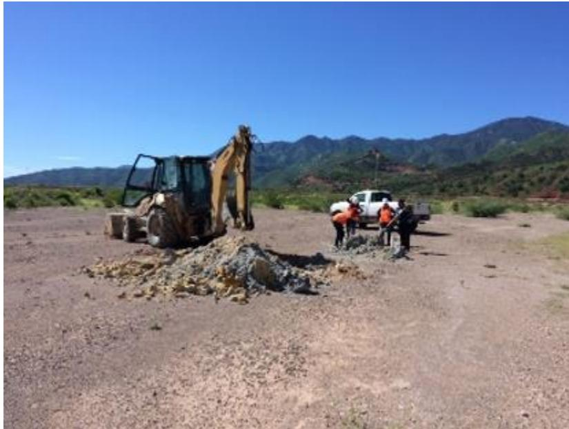
Figura 1. Fotografía tomada al momento de la recolección de muestra en la presa de jales.
