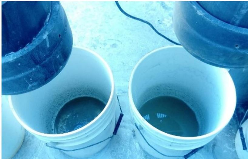
Figura 17. Percolación de la solución rica de las columnas 2 y 4 respectivamente, alimentadas con solución del biorreactor.
