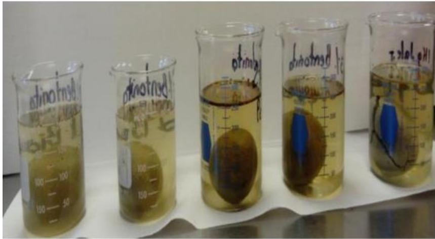
Figura 11. Representación de la prueba de permeabilidad, en donde se observan los pellets sumergidos en vasos de precipitado.
