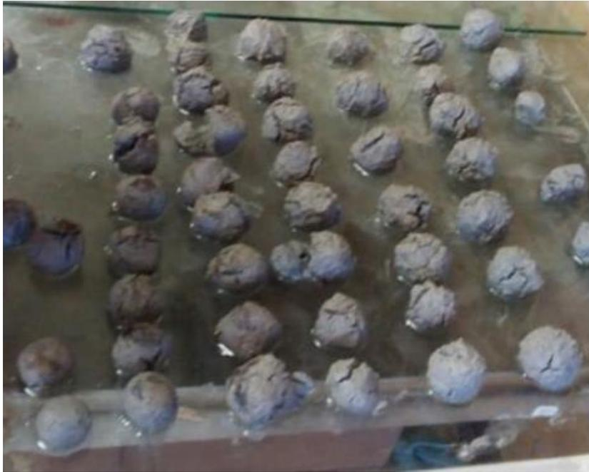
Figura 8. Fotografía de pellets formados con una mezcla de ácido sulfúrico y muestra seca de jales puestos sobre una superficie impermeable de vidrio secado a temperatura ambiente, tiempo de 3-4 días.
