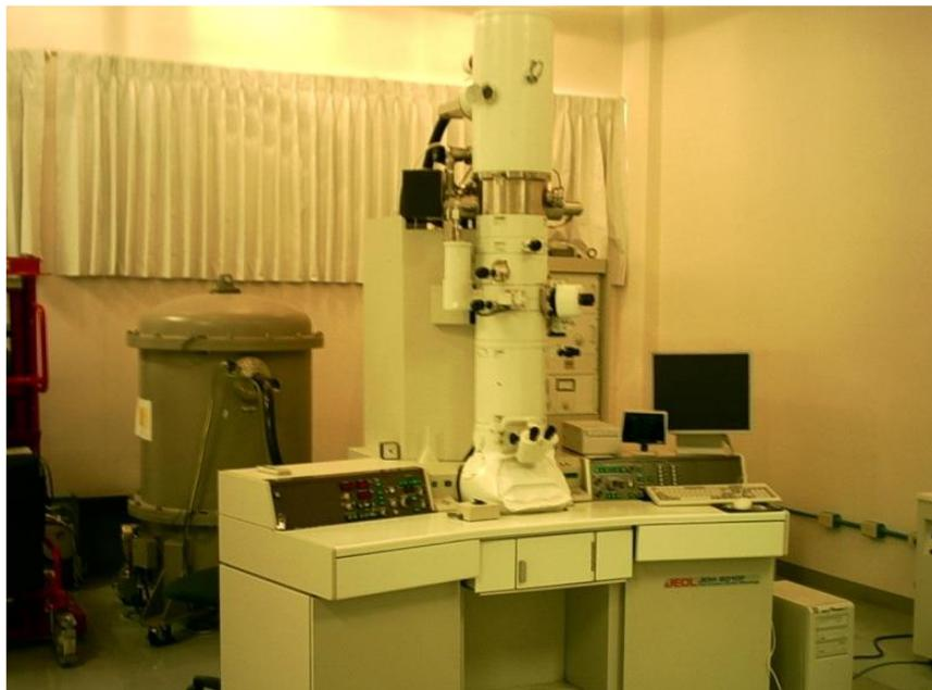
**Figura 10.** Microscopio Electrónico de Transmisión JEOL JEM2010F.
