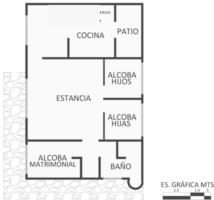
Imagen 2. Planta Arquitectónica - Prototipo de Vivienda para Obreros Mineros. Fuente: Dibujo propio en base al proyecto ganador. Diseñador Juan Legarreta.
