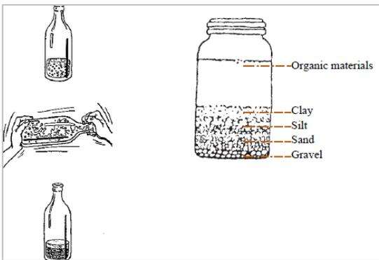
Figura 16: Esquema de procedimiento de la prueba de sedimentación. Fuente: Rigassi (1985)
