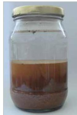
Figura 17: Prueba de Sedimentación mostrando materiales orgánicos, agua, arcilla, limo, arena y grava Foto del autor
