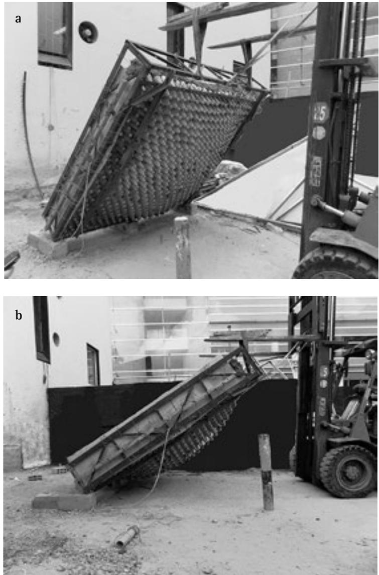
nuar con la prueba. Al analizar simultáneamente la Figura 9b con la Figura 10 es claro que el daño del sistema estructural y los desplazamientos de las botellas se concentraron en la mitad superior del mismo, con desplazamientos remanentes del orden de 35 mm.
