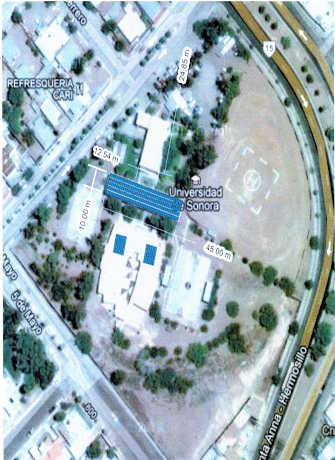
Figura 18. Simulación de la instalación fotovoltaica en Universidad de Sonora, *Campus Santa Ana* (Google, 2013).
