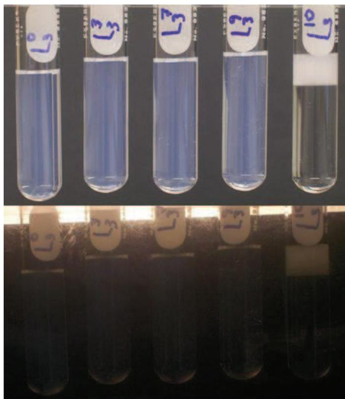
**Fig. 4.3:** Fases esponja con PEG20K a temperatura ambiente a simple vista (arriba) y entre polarizadores cruzados (abajo).
