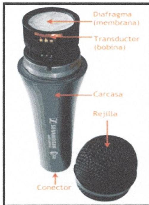
Figura 3.2. Partes de un micrófono de uso cotidiano.
