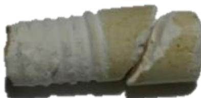
**Figura 17.** Pieza de wollastonita obtenida de maquinado
