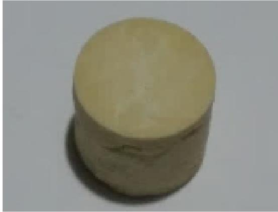
**Figura 15.** Pieza de wollastonita después del tratamiento térmico
