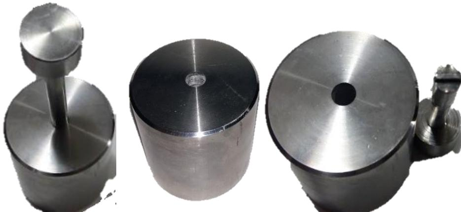
**Figura 13.** Molde basado en un troquel para pastillas
