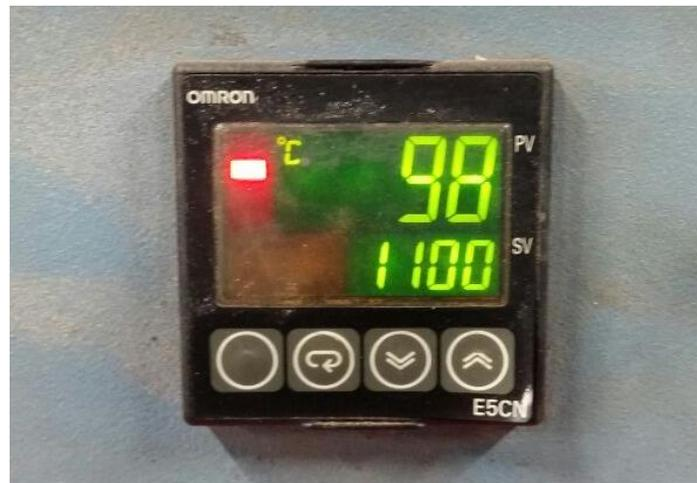
**Figura 9.** Indicador de temperatura de mufla de mufla utilizada.
