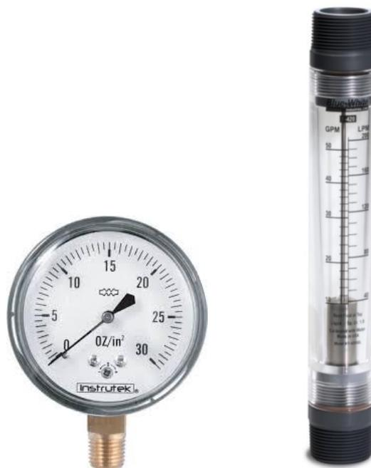
**Figura 17.** Manómetro y rotámetro utilizados.
