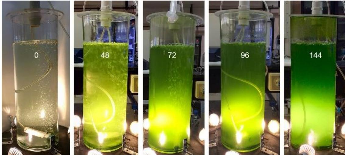
Figura 20. Seguimiento del tiempo de crecimiento en horas de la microalga de acuario en el reactor tipo Airlift, corridas 1-3
