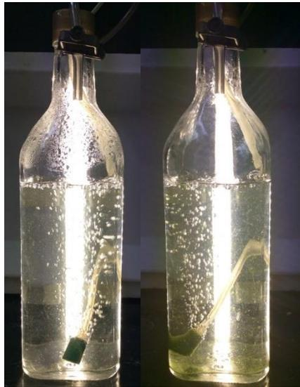
Figura 4. Sistema de cultivo utilizado en el primer escalamiento
