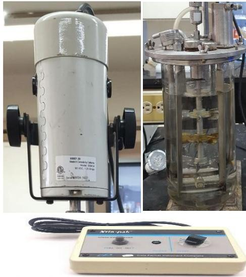
Figura 7. Cultivo de microalgas en fotobiorreactor instrumentado con agitación y alimentación de Aire 95% y CO<sub>2</sub> 5%
