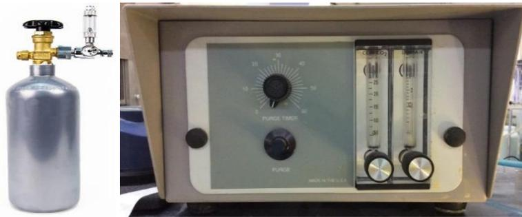
Figura 6. Sistema de suministro de gases en el cultivo de microalga.
