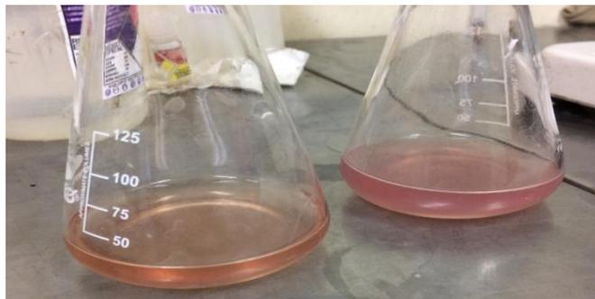
Figura 9. Soluciones cianuradas antes (izquierda) y después (derecha) de titular con nitrato de plata.
