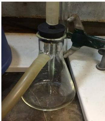
Figura 4. Matraz con la solución de NaOH (1 N).
