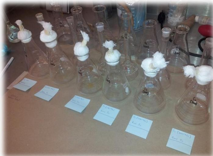
Preparación e inoculación de los matraces con el lodo acidogénico y las soluciones metálicas.
