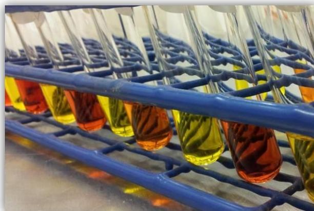
Medición de la concentración de dextrosa por el método del DNS.
