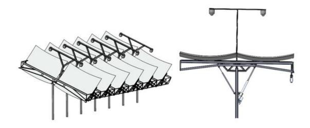
Figura 4.2. Vistas isométrica y lateral de mecanismo altazimutal.
