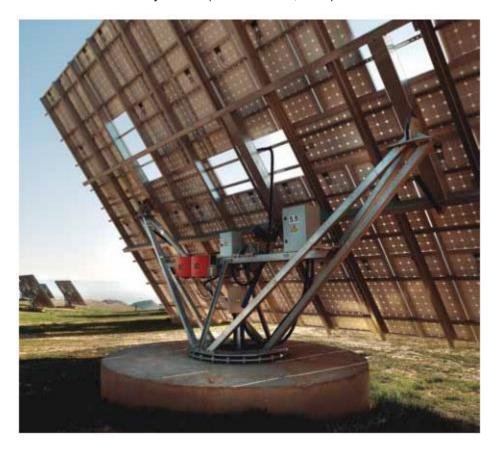
**Figura 2.9.** Modelo MS-E2 de Mecasolar con movimiento de elevación provisto por actuador lineal y movimiento azimutal por engranaje "slew-ring" (Mecasolar, 2014).
