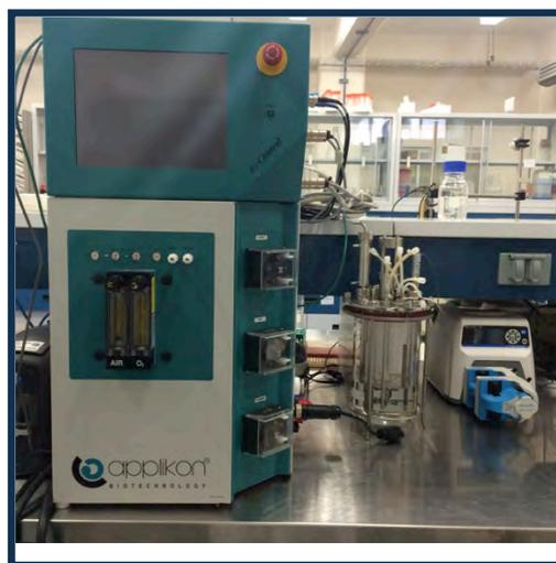
**Figura 19.** Biorreactor Applikon® (Holanda) de 2L acoplado al software ez-Control.
