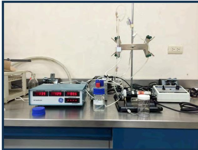
**Figura 21.** Sistema de Ultrafiltración tangencial.
