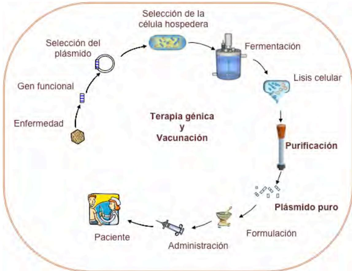
**Figura 5.** Esquema general del bioproceso para la obtención del pDNA (Adaptado de Prazeres y col., 2007).
