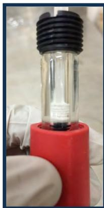
**Figura 33.** Empaque de columna intercalando membranas y soporte de propileno.
