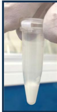
**Figura 35.** Lavado de partículas perfusivas en una solución de NaCl 1M y 0.5 M.
