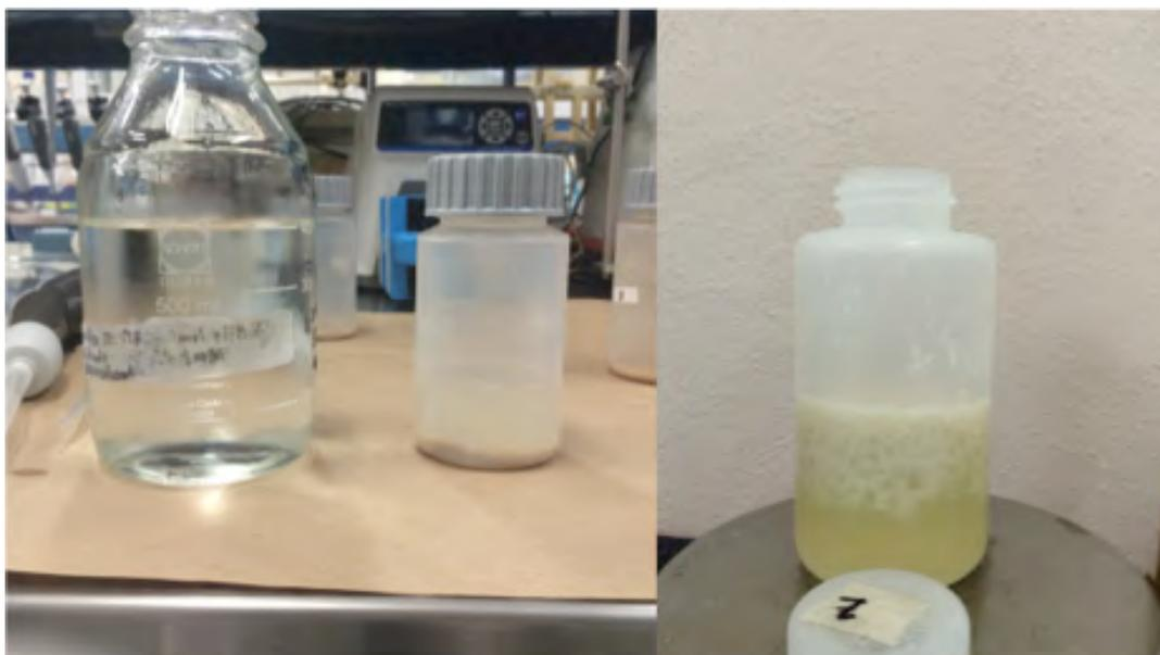
**Figura 40.** Biomasa obtenida por centrifugación (izquierda), flóculos formado de restos celulares e impurezas después de lisis alcalina y neutralización (derecha).
