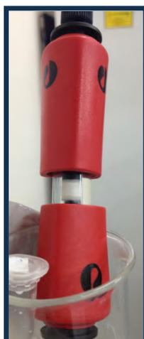
**Figura 36.** Empaque de columna Tricorn intercalando membranas y soporte de propileno.
