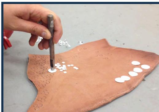
**Figura 32.** Ajuste de tamaño de membranas para poder ser empacadas en la columna Tricorn.
