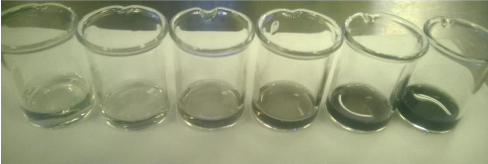
**Figura 18.** Diluciones en serie 1:1 de oxMWCNTs/PF-127 recubiertos a partir de 100  $\mu\text{g}/\text{mL}$ , con concentraciones de 50, 25, 12.5, 6.25 y 3.125  $\mu\text{g}/\text{mL}$ . (De derecha a izquierda, respectivamente).
