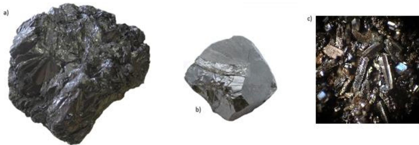
**Figura 1.** a) Grafito, b) Diamante, c) Fullerenos C<sub>60</sub>. Rocas en bruto.
