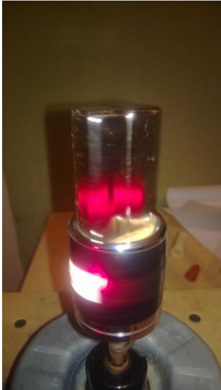
**Figura 16.** Sistema de imanes giratorios. Los imanes puestos a girar a 1000 rpm utilizando un tacómetro láser digital de no contacto.
