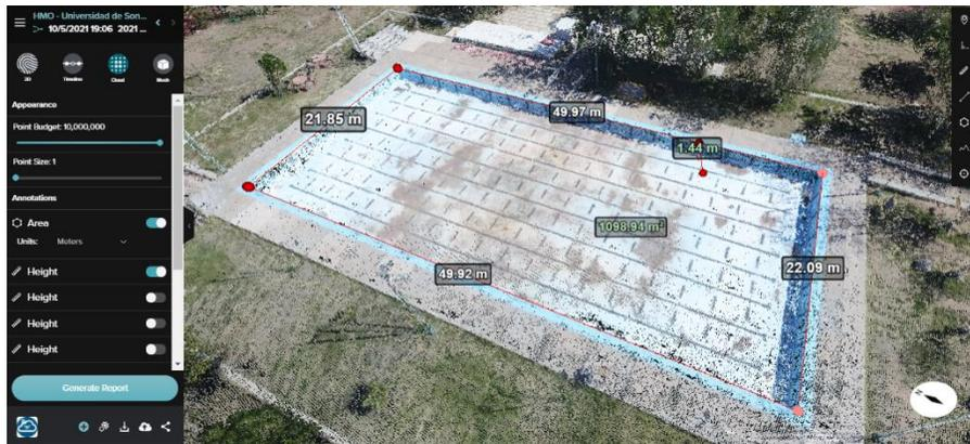
Figura 4.43. Visualización y medición de alberca olímpica en nube de puntos. Fuente: Elaboración propia
