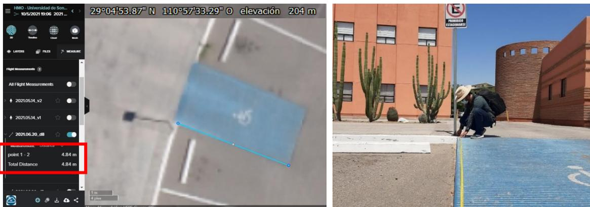
Figura 4.33. Comparativa de mediciones lineales en estacionamiento de bellas artes. A la izquierda la imagen procesada con fotogrametría y a la derecha la medición en campo. Fuente: Elaboración propia.
