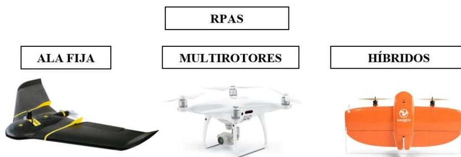
Figura 2.6 Tipos de RPAS. De izquierda a derecha: Modelo Ebee X, DJI Phantom 4 pro, Wingtra One. Fuente: Elaboración propia con imágenes de Google imágenes.
