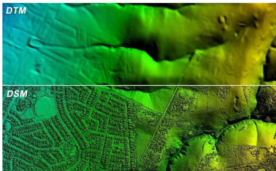
Figura 2.16. Diferencia visual entre un Modelo Digital de Terreno (DTM) y un Modelo Digital de Superficie (DSM). Fuente: [www.gisresources.com](http://www.gisresources.com)
