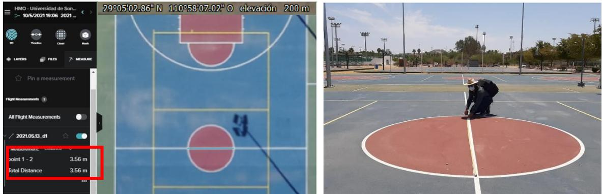
Figura 4.32. Comparativa de mediciones lineales en cancha de basquetbol. A la izquierda la imagen procesada con fotogrametría y a la derecha la medición en campo. Fuente: Elaboración propia.
