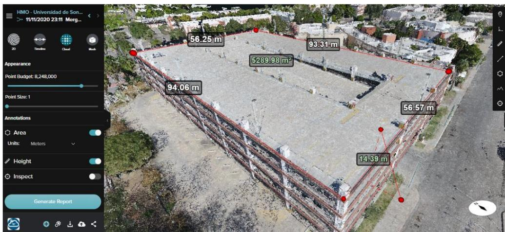
Figura 4.25. Medición de área y perímetro de estacionamiento multinivel de la Universidad de sonora en nube de puntos. Fuente: Elaboración propia.
