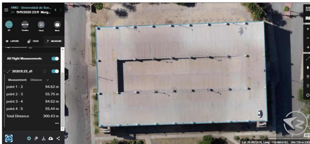
Figura 4.26. Medición de perímetro de estacionamiento multinivel de la Universidad de sonora en orto fotografía. Fuente: Elaboración propia.
