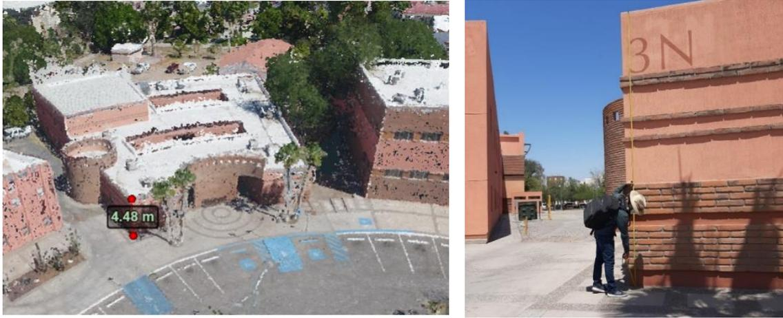
*Figura 4.39. Medición de altura en edificio 3-N de Música en modelo digital y comprobación en sitio. Fuente: Elaboración propia.*
