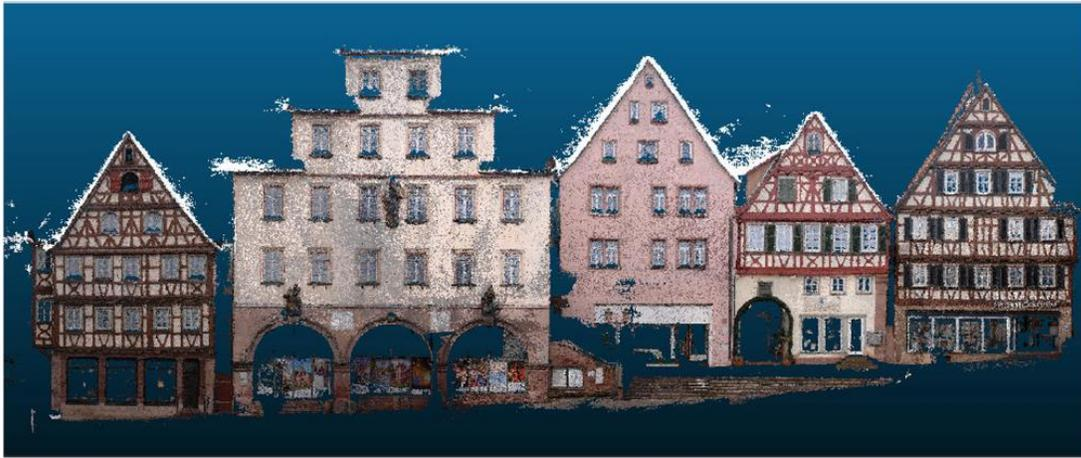
Figura 2.21. Vista frontal de nube de puntos del objeto de estudio y los edificios vecinos. Fuente: Dieter Fritsch et al., 2017
