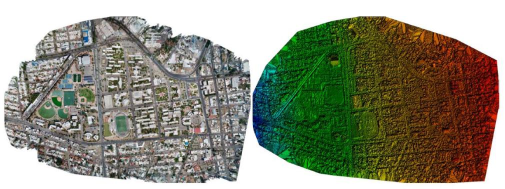
Figura 4.16 Ortofotografía y Modelo Digital de Superficie (MDS) previo a la densificación de imágenes.
