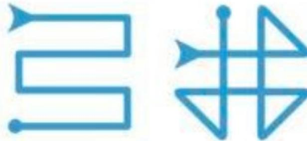
*Figura 4.10. Diagramas de planes de vuelo, de izquierda a derecha: Mapeo de área y mapeo entrelazado. Fuente: Sitiescan App*
