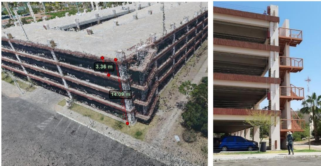
*Figura 4.38. Medición digital y comprobación en sitio de distancias verticales en estacionamiento multinivel. Fuente: Elaboración propia.*
