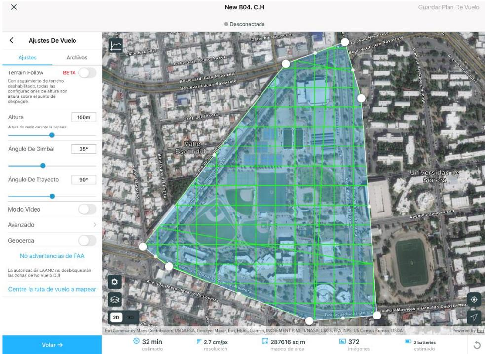
Figura 8.6. Figura 42. Configuración de vuelo tipo mapeo entrelazado para bloque 04. Fuente: Elaboración propia.
