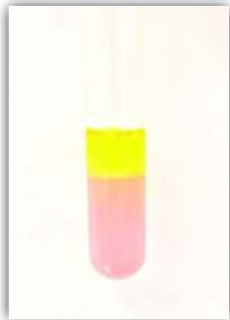
Figura 4. Mezcla de reacción después de concluir la titulación y el viraje a color rosa durante la determinación de actividad de la lipasa.
