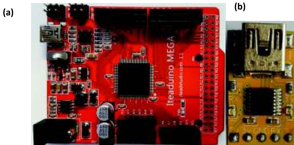
Figura 8. Hardware utilizado para el monitoreo del índice de calidad de agua a) tarjeta de desarrollo Iteaduino/Arduino, b) depurador.
