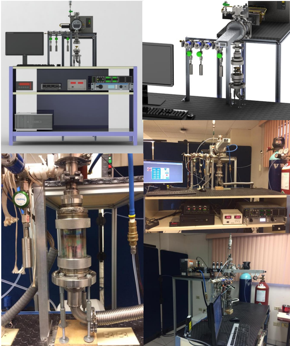
Figura 28. Sistema ALD asistido por plasma completo y funcional.
