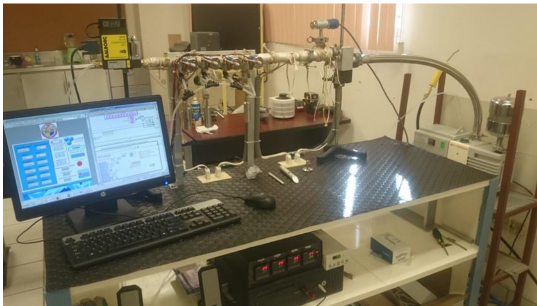
Figura 15. Sistema ALD Térmico completo y funcional.
