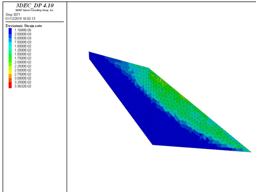
Figura 118. Contorno de la velocidad de deformación desviadora en la cuña en 3DEC.
