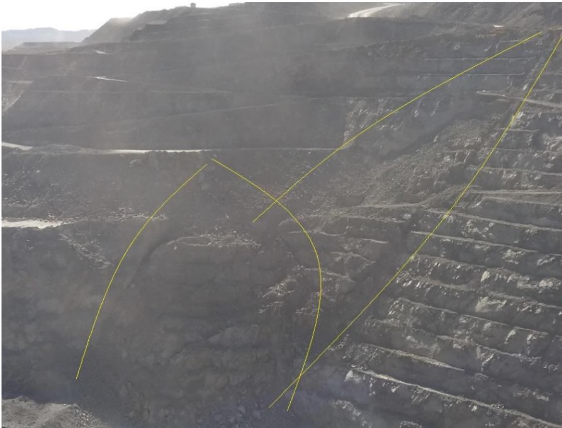
**Figura 109.** Formación de cuñas en el talud sur.
