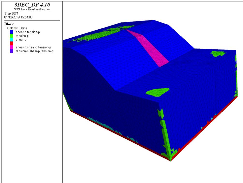
Figura 117. Estado de los elementos en 3DEC.
