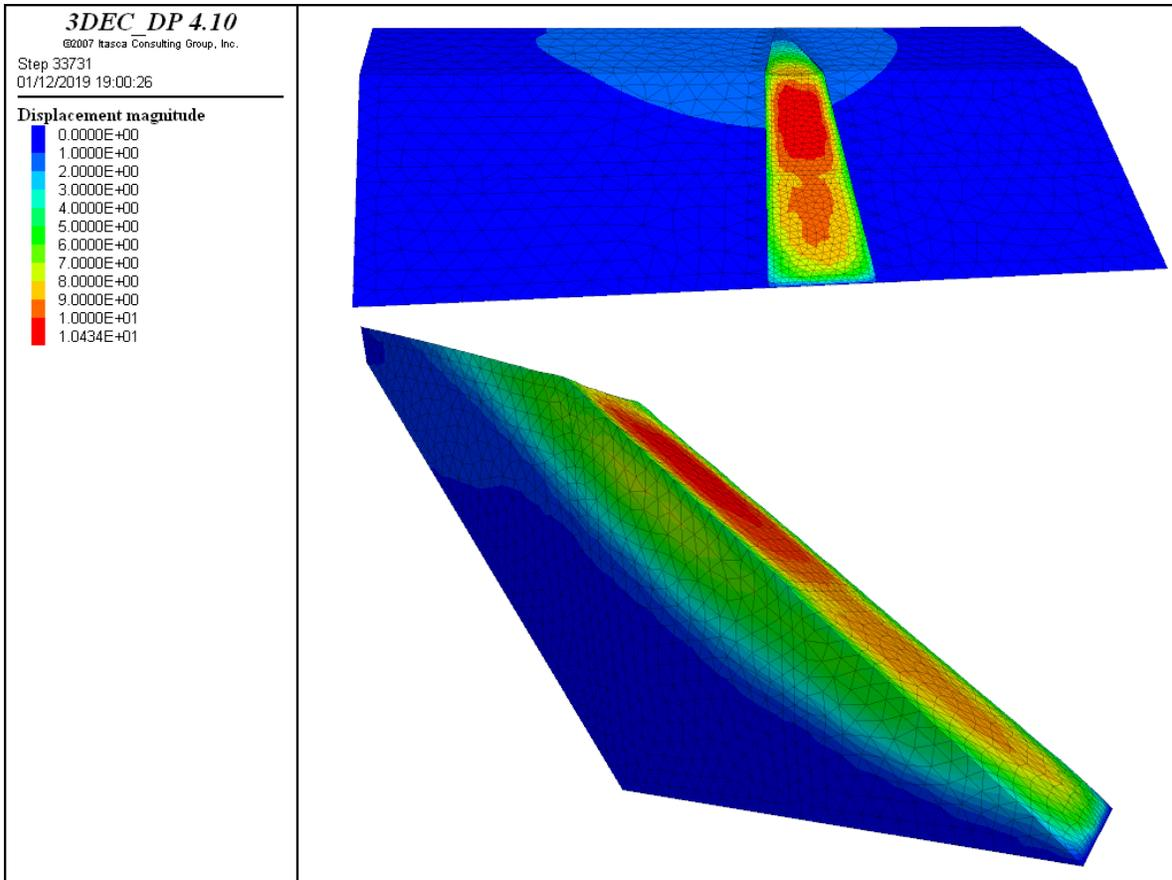
**Figura 119.** Contorno del desplazamiento total en 3DEC.
