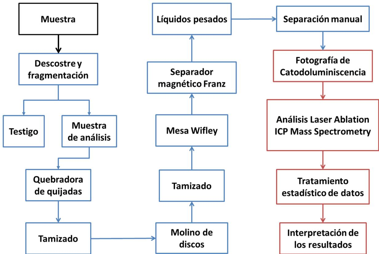
Figura 127. Procedimiento utilizado para la separación de minerales.
