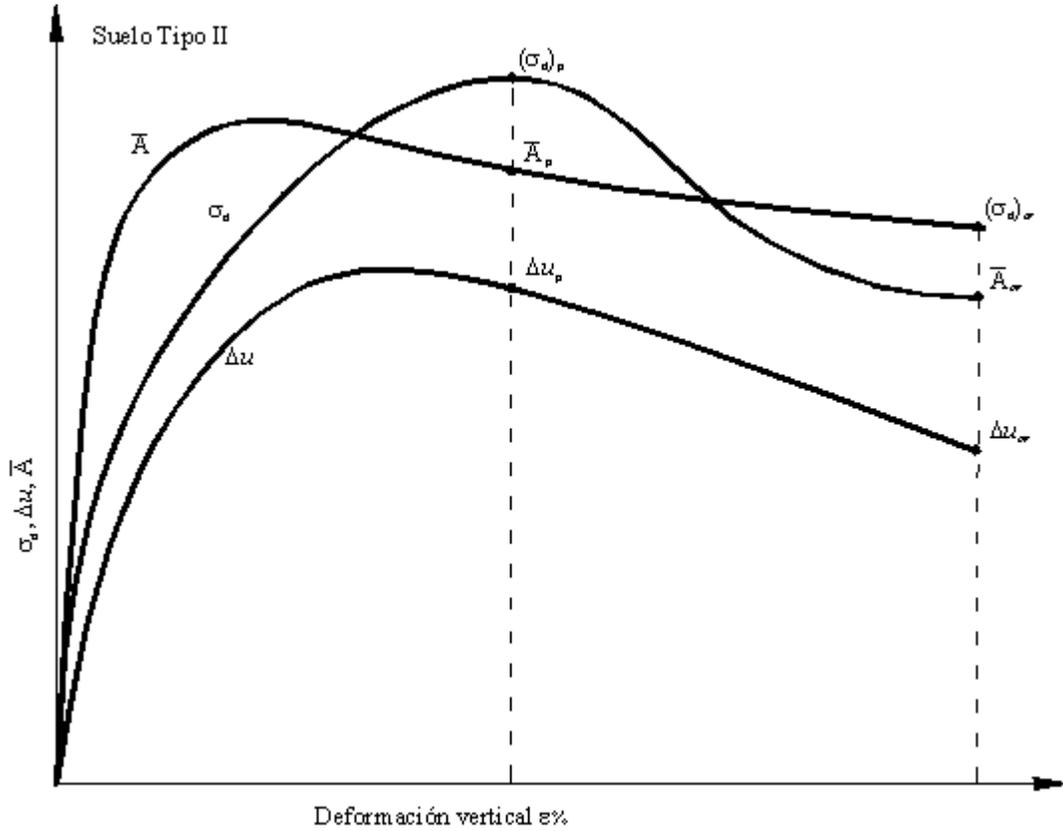
Figura 129. Deformación vertical en función a  $\sigma_d$ ,  $\Delta u$  y  $\bar{A}$  en un triaxial CU en suelo Tipo II.
