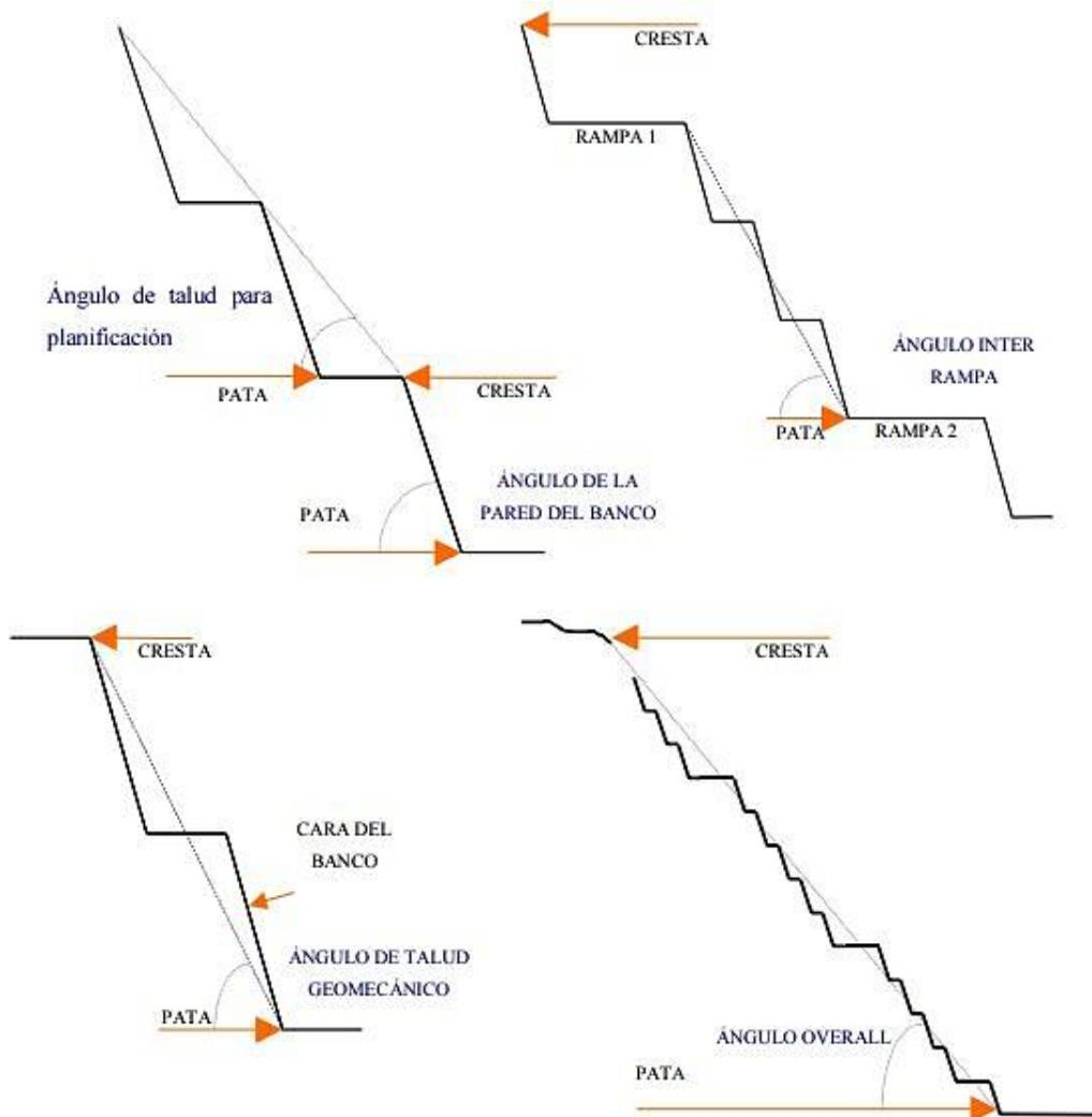
**Figura 110.** Esquema de definición de ángulos según el talud de análisis. **Fuente:** Diseño de Minas a cielo abierto, Universidad de Chile.
