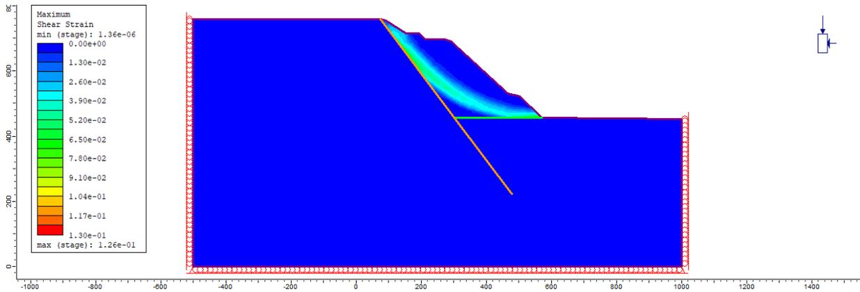
**Figura 120.** Contorno de la deformación cortante máxima en RS2.
