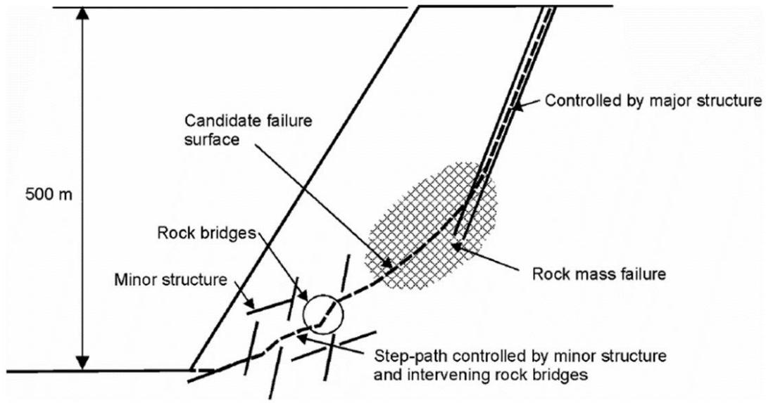
**Figura 108.** Mecanismo de falla compleja para un talud minero de gran escala. **Fuente:** (Hoek *et al*, 2000).
