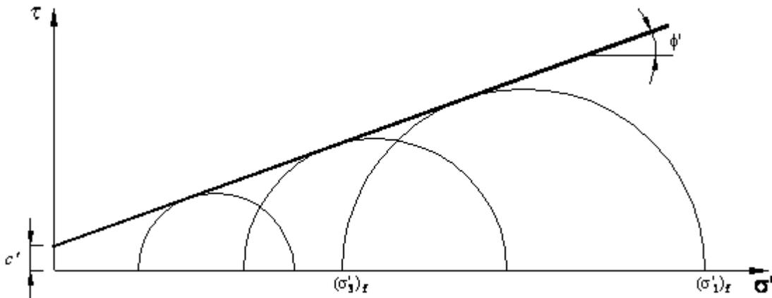
Figura 130. Envolvente de falla para un suelo Tipo II en un ensayo triaxial CU.
