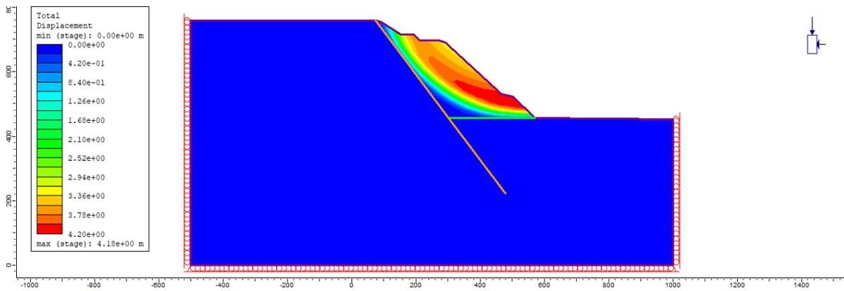
**Figura 121.** Contorno del desplazamiento total en RS2.
