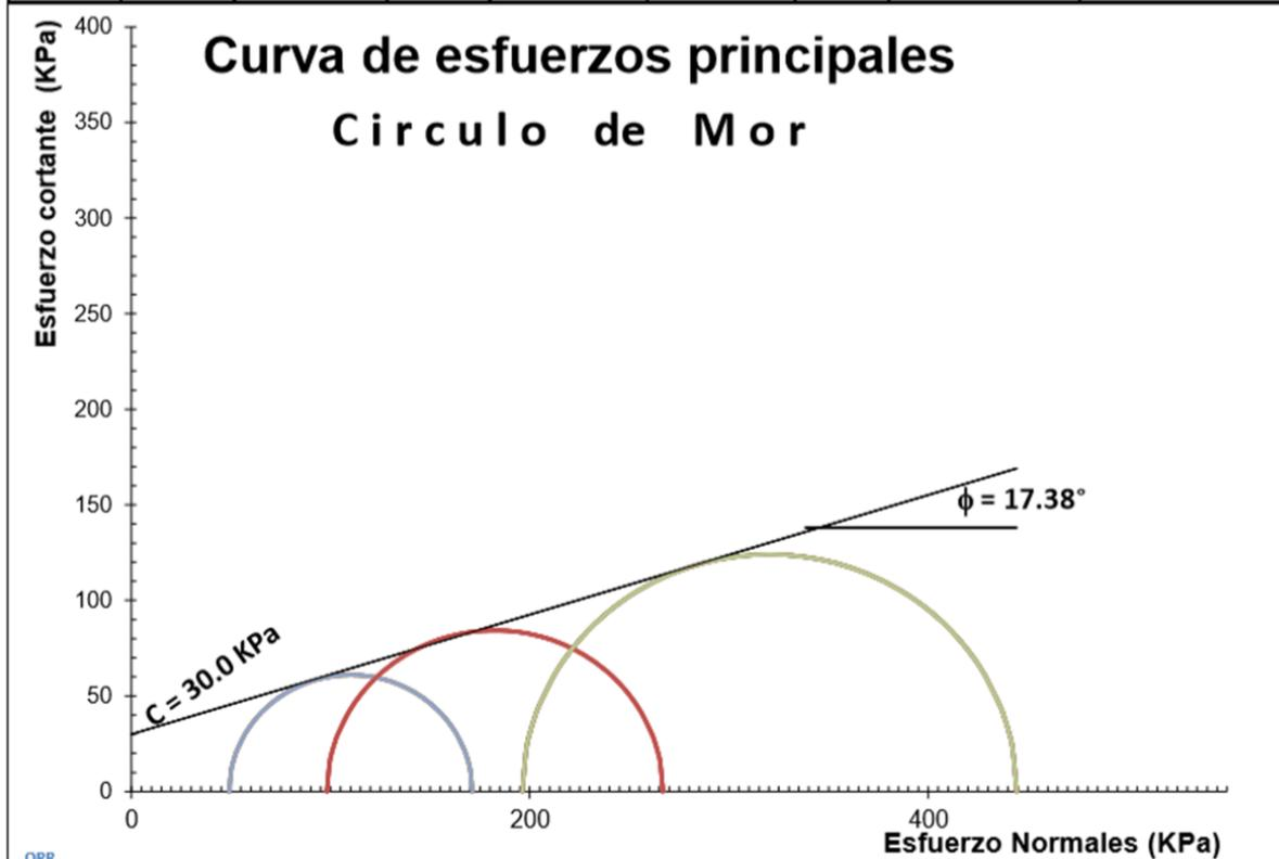
Figura 113. Resultados de prueba triaxial rápida para la obtención de parámetros geotécnicos (C y  $\phi$ ) para el material de relleno de falla en condiciones saturadas.
