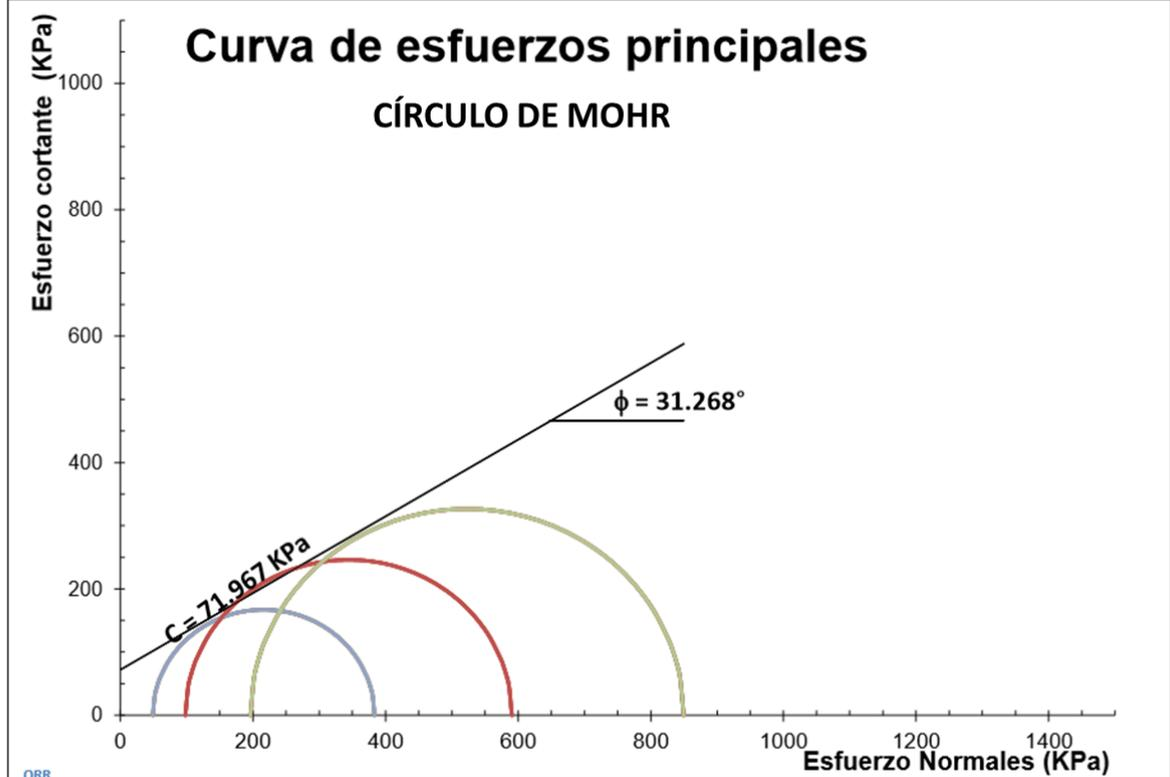
Figura 112. Resultados de prueba triaxial rápida para la obtención de parámetros geotécnicos (C y φ) para el material de relleno de falla en condiciones secas.
