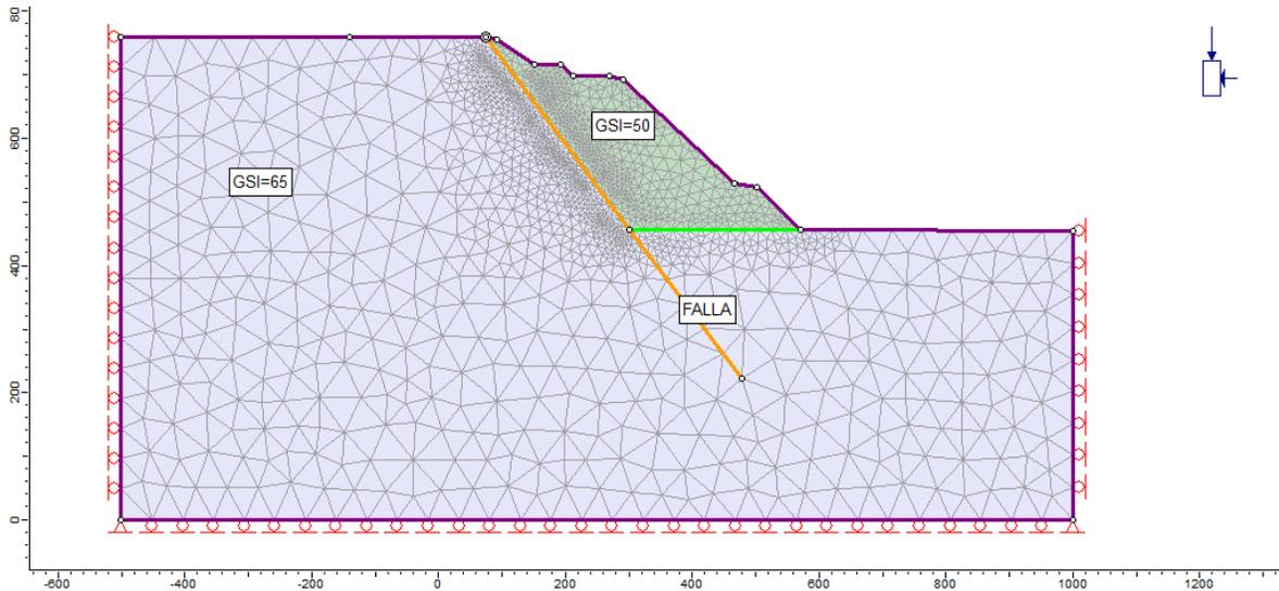
**Figura 116.** Modelo de elementos finitos en 2D.
