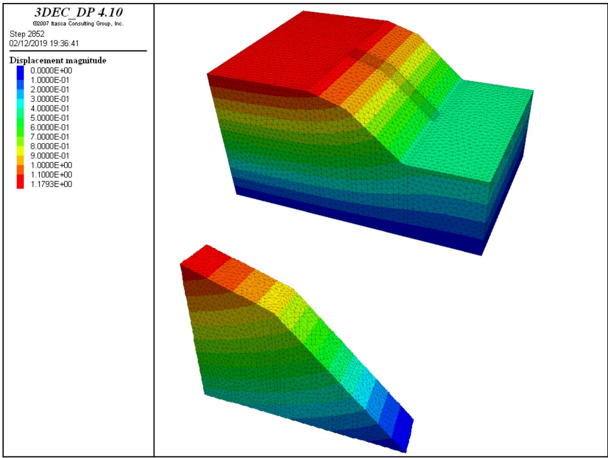
**Figura 122.** Contorno de desplazamiento en el talud sin la presencia de estructuras mayores.
