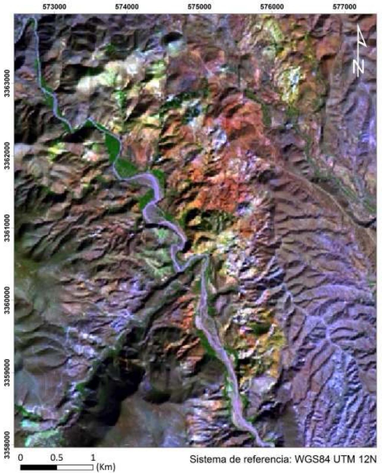
**Figura 35.** Combinación de bandas RGB (7, 5, 2) de la imagen del sensor Landsat 8.
