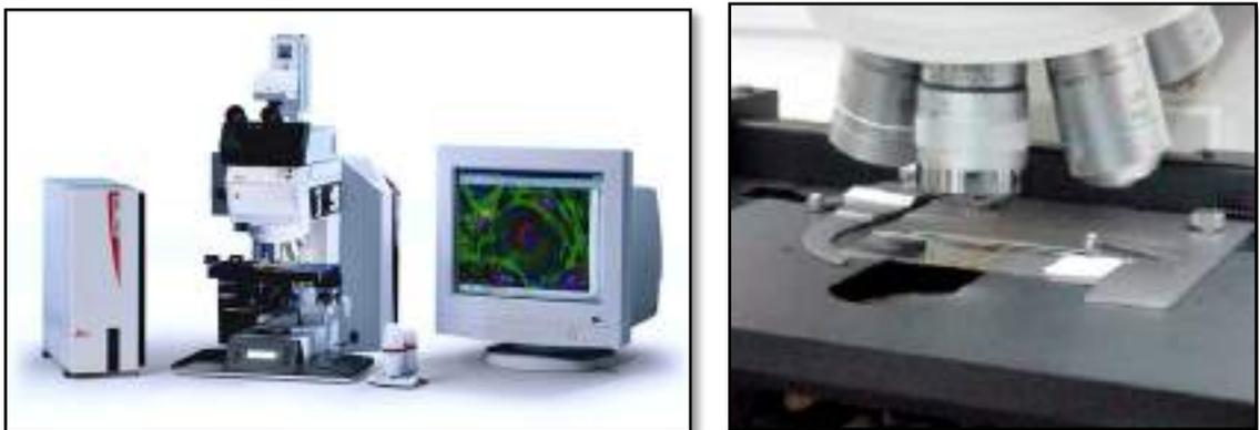
**Fig. 11** Microscopio *Leica DM RXA2* con platina motorizada para  $X/Y$  y  $Z$  desplazamientos.
