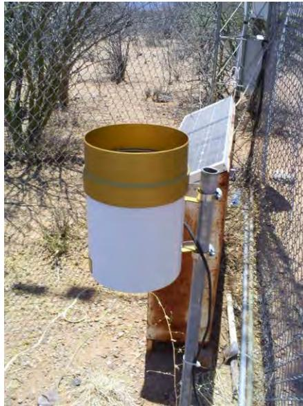
Figura 27. Pluviógrafo de balancín, ubicado en la estación La Torre
