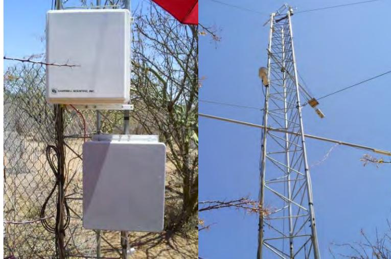
Figura 26. Controladores y sensores de la estación La Torre (Rayón, Sonora)
