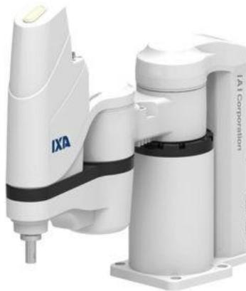
*Figura 2. 17 Robot tipo SCARA desarrollado por la compañía IXA.*
