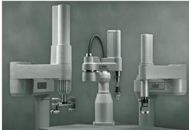
*Figura 1. 8 Ejemplos de AdeptOne de SCARA robots. [16]*
