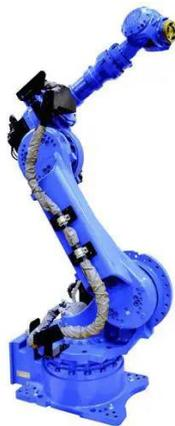
*Figura 1. 19 Robot articulado MC2000 II de YASKAWA.*
