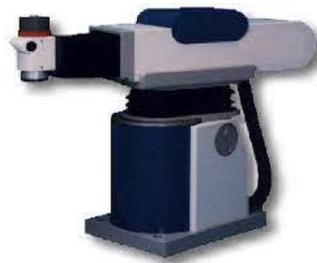
Figura 2. 11 Robot de configuración cilíndrica modelo RT3200 por SEIKO
