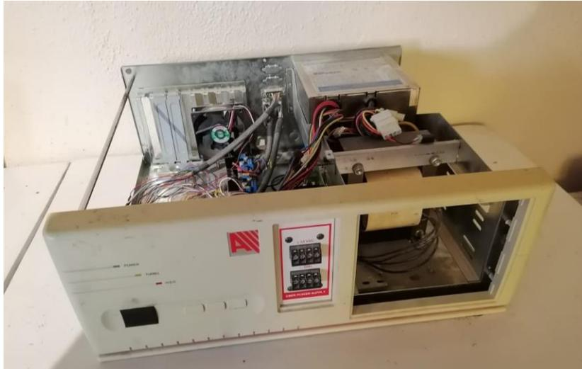
*Figura 5. 1 Gabinete de control original del robot Pegasus de AMATROL.*
