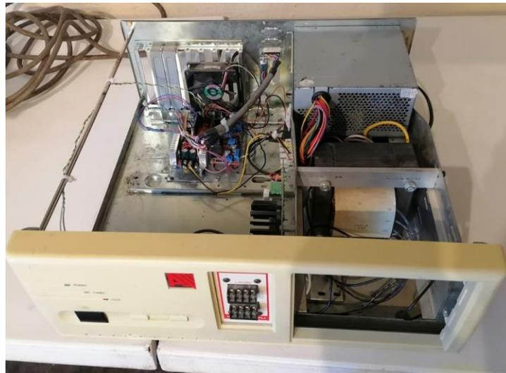
*Figura 5. 2 Gabinete habilitado para el control del robot Pegasus de AMATROL.*
