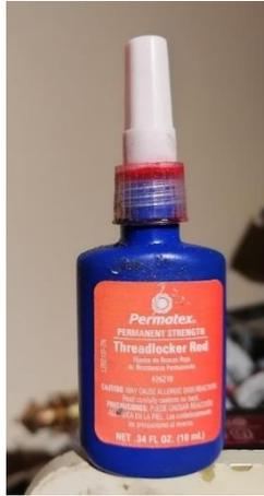
Figura 2. 36 Fijador de tornillos y tuercas utilizado en el proyecto. Autoría propia.
