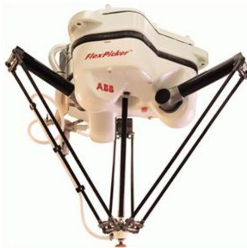
*Figura 1. 10 El robot FlexPicker de ABB. [16]*
