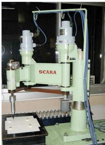
*Figura 1. 7 Uno de los primeros prototipos de Robot SCARA, diseñado por Hiroshi Makino. [16]*
