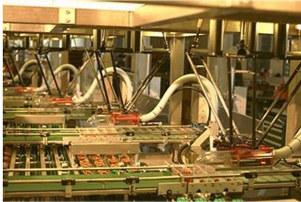
*Figura 1. 9 Robots Delta en las celdas de trabajo de Demarex para el empaquetamiento de pretzels. [16]*
