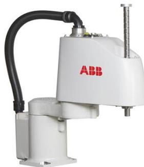
*Figura 1. 16 Robot IRB 910SC de ABB tipo SCARA.*
