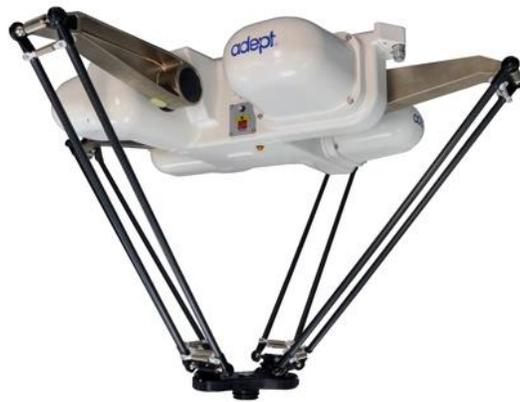
Figura 2. 23 Robot Delta Omron Paralelo por la compañía adept.
