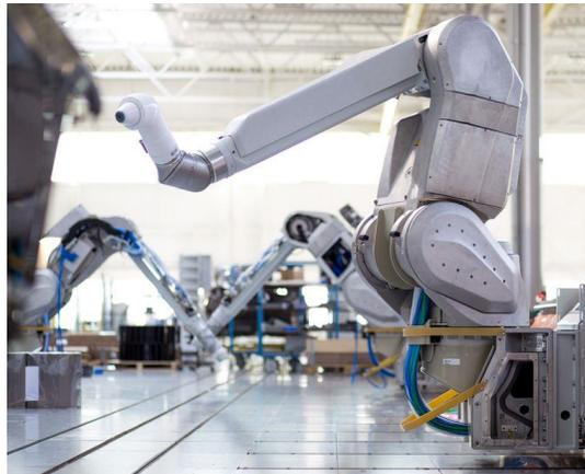
*Figura 1. 18 Robot EcoRP E043i para pintura automotriz de Dürr.*
