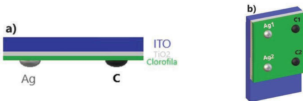
Figura 10. Esquema estructural de electrodo de trabajo de una celda Grätzel. Vista lateral (a) e isométrica (b).
