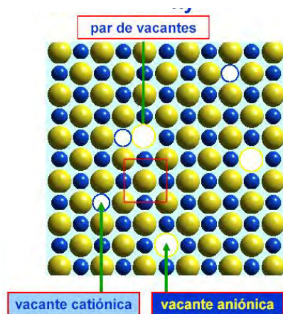
Figura b.1. Representación de un defecto Schottky presente en un cristal. [30]
