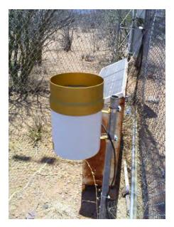
Figura 27. Pluviógrafo de balancín, ubicado en la estación La Torre
