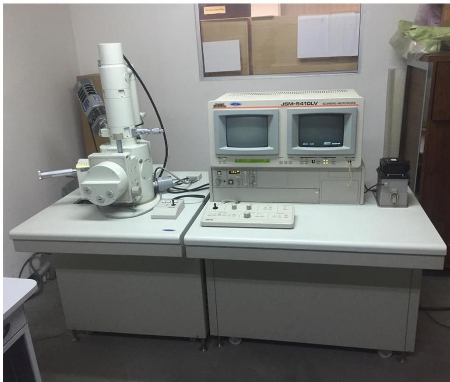
Foto 3.2 Microscopio electrónico de barrido JEOL JSM-5410LV del Departamento de Investigación de Polímeros y Materiales de la Universidad de Sonora
