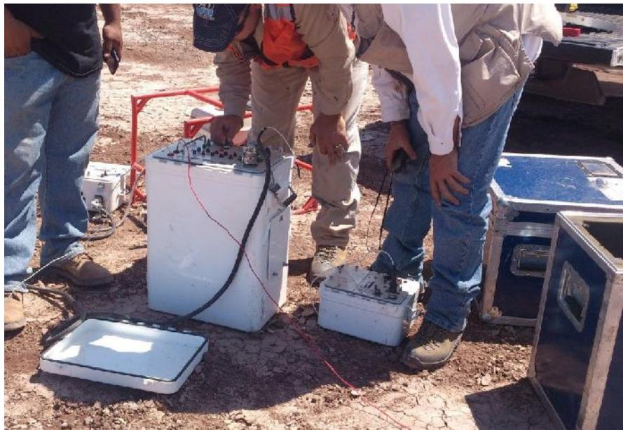
Figura 16. Equipo transmisor Scintrex/Zonge GGT-3, controlador transmisor XMT-32 y generador ZMG-3.
