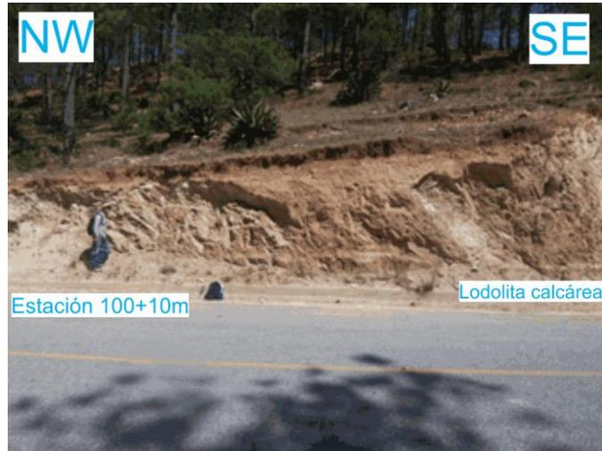
**Figura 79.** Fotografía de campo con orientación NW-SE, viendo al NE, mostrando el afloramiento expuesto en la estación 100+10 m. Se observa que la lodolita calcárea es altamente deleznable, es una zona fuerte de tectonismo, mostrando imbricaciones tectónicas en la lodolita (**Figura 80**).
