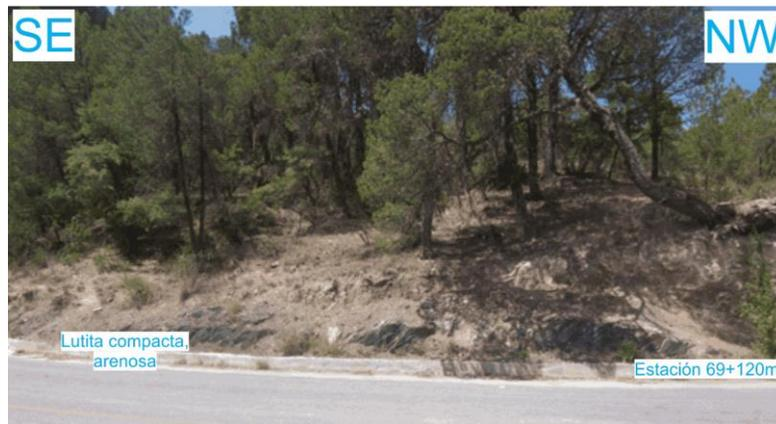
**Figura 46.** Fotografía de campo con orientación SE-NW, viendo al SW, mostrando el afloramiento de lutita compacta, arenosa de color pardo oscuro a negro en superficie fresca, expuesto en el intervalo de la estación 69+120 m a 69+135 m (**Figura 47**).
