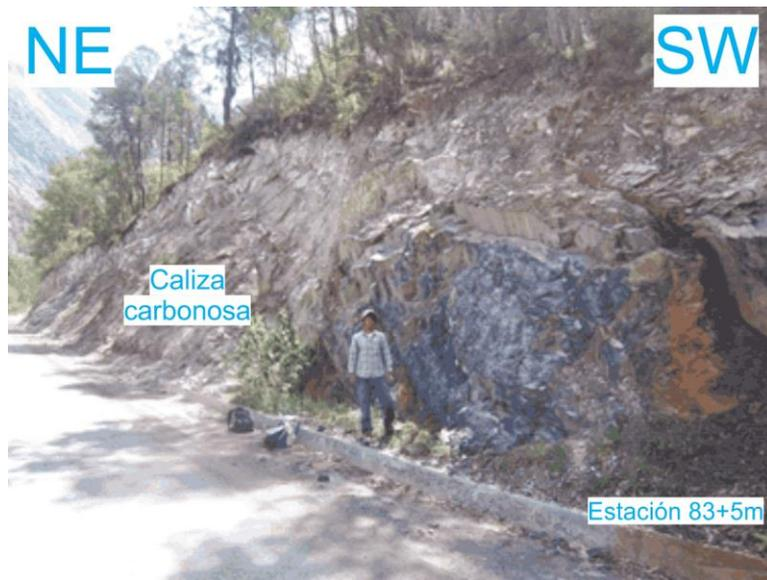
**Figura 60.** Fotografía de campo con orientación NE-SW, viendo al SE, mostrando el afloramiento expuesto en el intervalo de las estaciones 83 a 84. Al SE se observa el color pardo oscuro, en superficie al intemperismo, de la caliza carbonosa.
