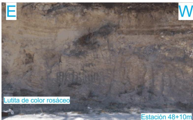
**Figura 24.** Fotografía de campo con orientación E-W, viendo al sur, mostrando el afloramiento expuesto en la estación 48+100 m. Lutita de color rosáceo es altamente frías y fuertemente fracturado.
