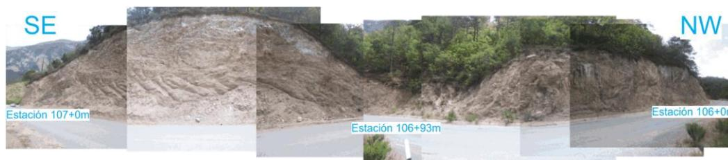
**Figura 90.** Fotografía de campo con orientación SE-NW, viendo al SW, montando la sucesión estratigráfica expuesta en el intervalo de las estaciones 106+0 m a 107+0 m. Nótese la cañada que separa el intervalo en dos partes, al mismo tiempo que se observa el plegamiento de la secuencia estratigráfica (**Figura 88**).
