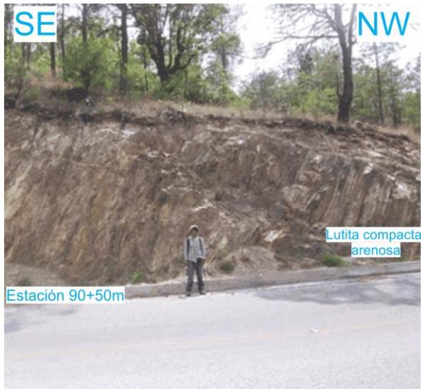
**Figura 75.** Fotografía de campo con orientación SE-NW, viendo al SW, mostrando el afloramiento expuesto en el intervalo de las estaciones 90+50 m a 91. Se observa que de NW hacia SE la caliza carbonosa se acentúa mucho más.
