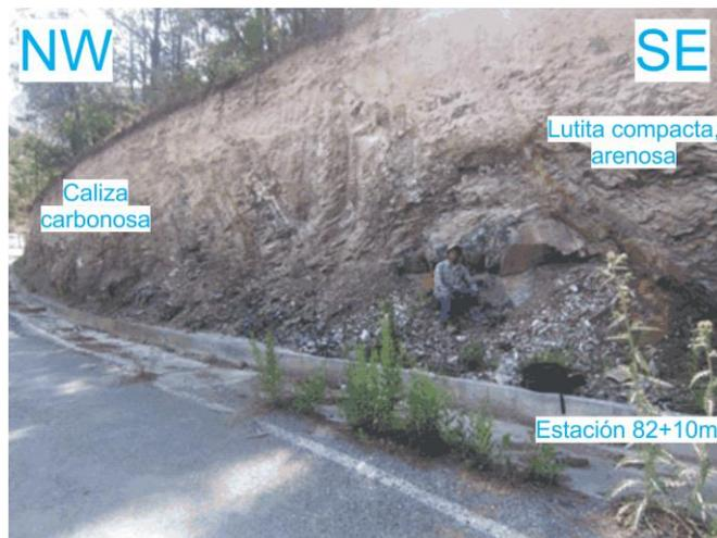
**Figura 58.** Fotografía de campo con orientación NW-SE, viendo al NE, mostrando el afloramiento expuesto en el intervalo de las estaciones 82 a 83. El paquete que se observa al SE es de lutita compacta, arenosa mientras que al NW aflora la caliza carbonosa (**Figura 59**).
