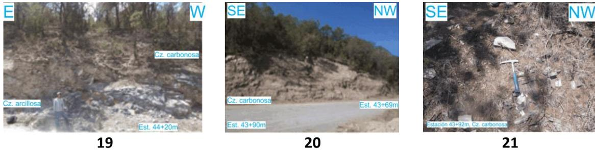
**Figuras 19, 20 y 21.** Afloramiento del paquete de caliza carbonosa, expuesto en el intervalo de las estaciones 43+69 m a 43+94 m. Este paquete es muy susceptible a la erosión. La fotografía 19 fue tomada con orientación E-W, viendo al sur. La fotografía 20 fue tomada con orientación SE-NW, viendo al SW. La fotografía 21 fue tomada con orientación SE-NW, viendo, ligeramente vertical, al SW.
