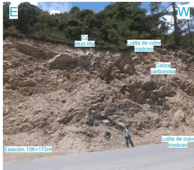
**Figura 89.** Fotografía de campo con orientación E-W, viendo al sur, mostrando el afloramiento expuesto al final de la estación 106. Se observa el horizonte de caliza wackestone y de caliza carbonosa.
