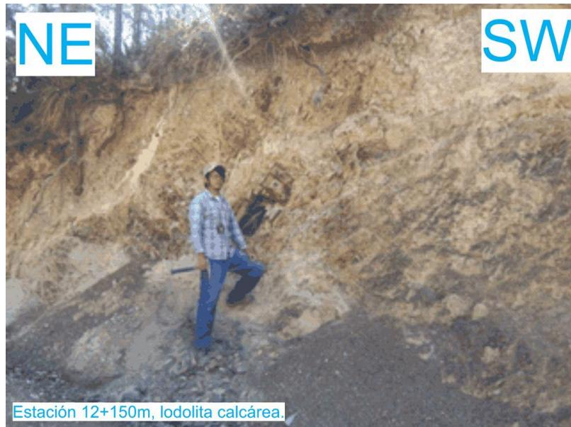
**Figura 10.** Fotografía de campo con orientación NE-SW, viendo al SE, mostrando el afloramiento de la estación 12+150 m, se observa el carácter deleznable de las lodolitas debido a que presentan poca estabilidad.
