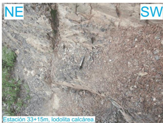
**Figura 17.** Fotografía de campo con orientación NE-SW, viendo al SE, mostrando el afloramiento expuesto en la estación 33+15 m. Se muestra el paquete de lodolita calcárea, altamente deleznable, de la estación 33+15 m, la foto fue tomada en forma prácticamente vertical, es decir, viendo ligeramente al suelo.
