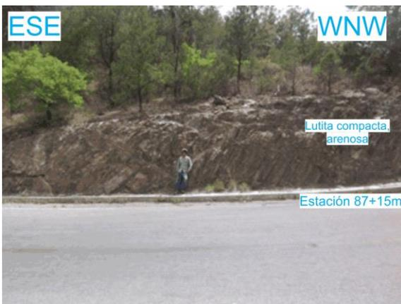
**Figura 68.** Fotografía de campo con orientación ESE-WNW, viendo al SW, mostrando el afloramiento expuesto en el intervalo de las estaciones 87 a 88. Se observa la continuidad de la lutita compacta, arenosa, asimismo se muestra que la orientación de las capas mantiene la dirección del echado al sur.
