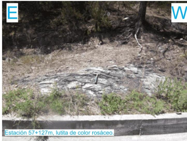
**Figura 30.** Fotografía de campo con orientación E-W, viendo al sur, mostrando parte del afloramiento expuesto en el intervalo de las estaciones 57+100 m a 57+150 m. La lutita de color rosáceo es muy delznable.
