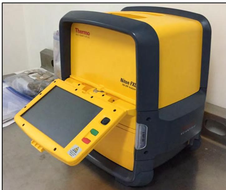
**Figura 17.** Equipo portátil de fluorescencia de rayos x (FRXP) con tubos miniaturizados marca *Thermo Scientific Niton* modelo *FXL*.
