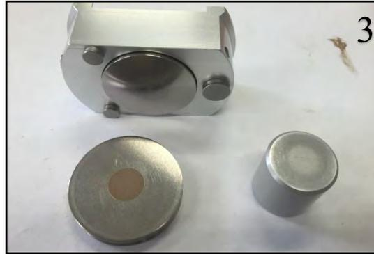
**Figura 23.** Preparación de muestra utilizando porta-muestra de doble fondo en el equipo *PANalytical Empyrean*. 1. Sujetador y anillo relleno con la muestra. 2. Adaptación de base al anillo con cavidad rellena. 3. Desprendimiento del sujetador liberando la base y anillo con muestra.
