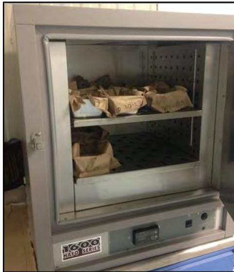
**Figura 12.** Horno de secado al aire modelo VWR 1600 HAFO Series.
