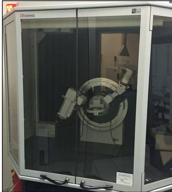
**Figura 20.** Cabina del difractómetro *Bruker* modelo *D8 Advance*.
