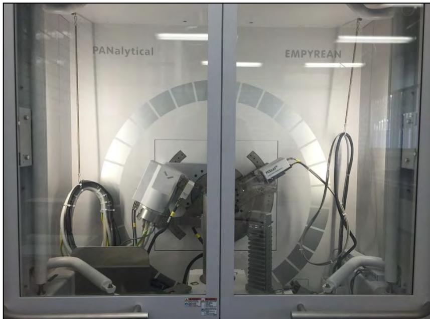
**Figura 19.** Cabina del difractómetro *PANalytical* modelo *EMPYREAN*.
