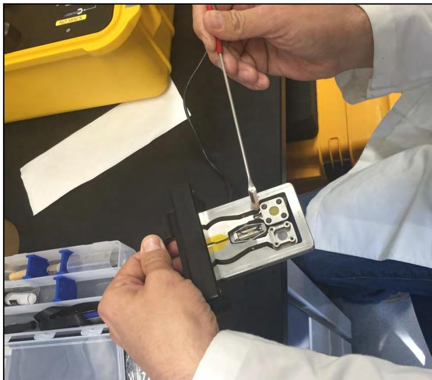
**Figura 24.** Celda vibrante utilizada en el equipo portátil *Olympus* modelo *Terra-476*.
