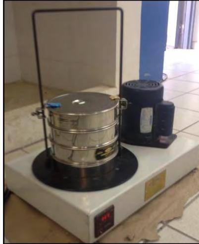
**Figura 13.** Ro-Tap Tyler Modelo RX-86 y torre de tamices utilizados.
