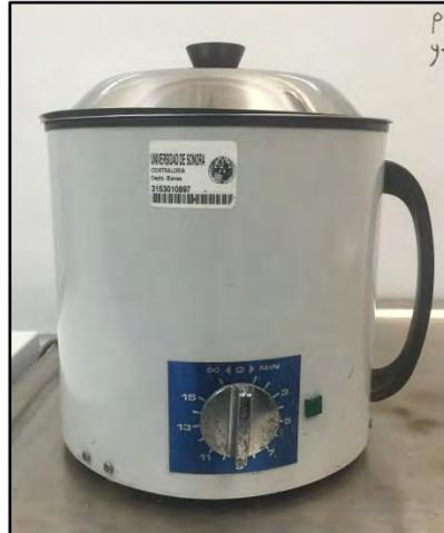
**Figura 15.** Baño ultrasónico utilizado en la limpieza de tamices.
