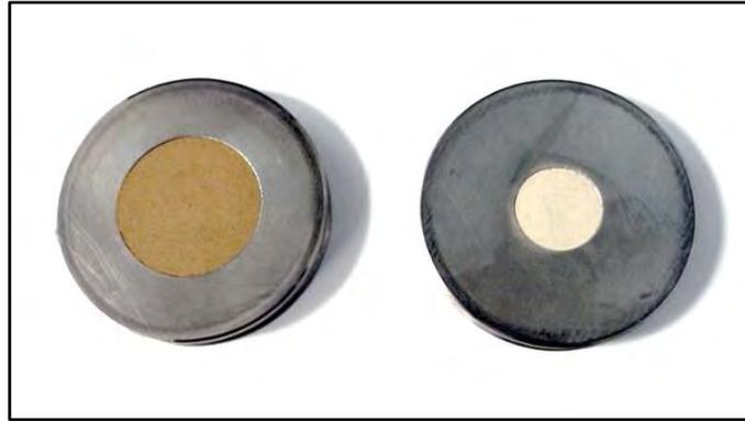
**Figura 22.** Porta-muestra ordinario de simple cavidad utilizada en equipo *Bruker* modelo *D8 Advance*.
