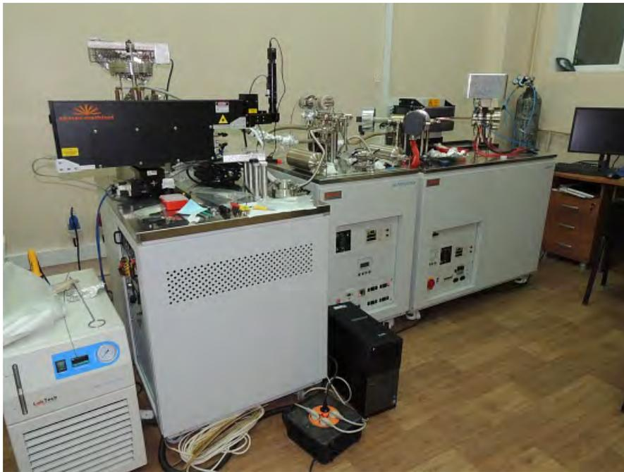
**Figura 1.6:** Espectrómetro de masas de gases nobles ARGUS VI.
