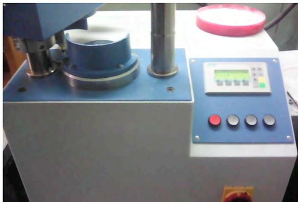
**Figura 1.3:** Prensa hidráulica semi-automática HERZOG HTP-40.
