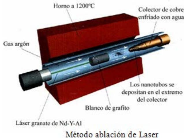
Figura 11 Diagrama del método de síntesis de nanotubos de carbono por vaporización láser de grafito.
