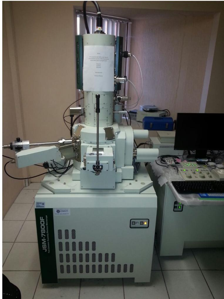
FIGURA 5.2: Microscopio electrónico de barrido JSM-7800F
