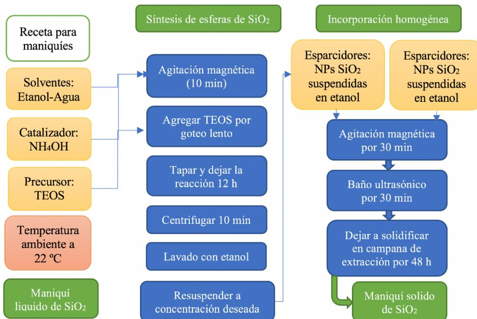
Fig. 4. Procedimiento para la elaboración de los maniqués ópticos con NPs de  $\text{SiO}_2$ .
