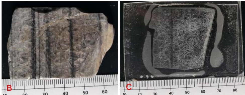
Fotografía 6. En la muestra de mano (A) **PB16-29A** se observa una matriz vítrea con lustre turbio y laminaciones de minerales opacos, en el testigo (B) se aprecia una fractura concoide con textura fibrosa, y en sección delgada (C) es más notorio el desarrollo de la fractura concoide.
