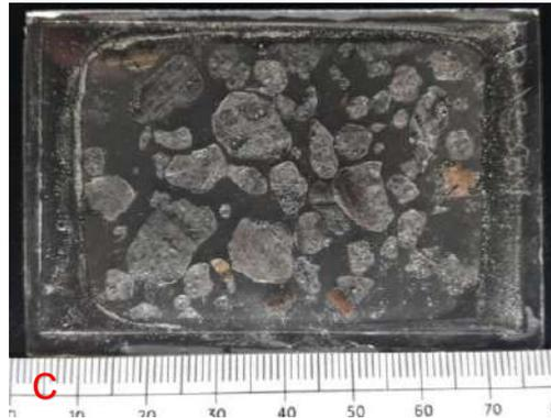
Fotografía 177. En la muestra de mano (A) **PB16-28A** se observa un material granulado de perlita en tamaños menores a 1.5 centímetros, en el testigo (B) se observan fragmentos granulares sumergidos en resina, y en sección delgada (C) se observan fragmentos perlíticos con laminaciones de minerales opacos y fayalita.
