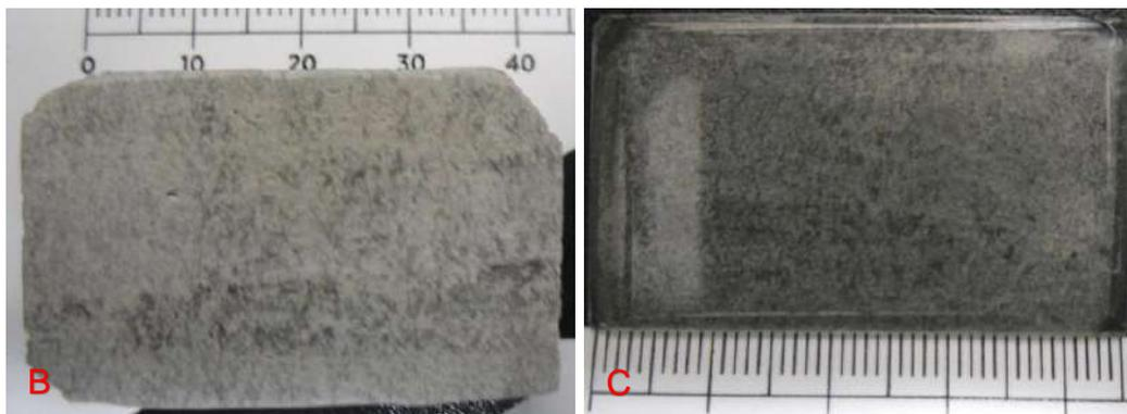
*Fotografía 9. En la muestra de mano (A) **PB16-01** podemos observar una matriz vítrea con textura afanítica y fractura perlítica, en el testigo (B) se observa un lustre opaco, y en sección delgada (C) no se distingue la fractura concoide.*
