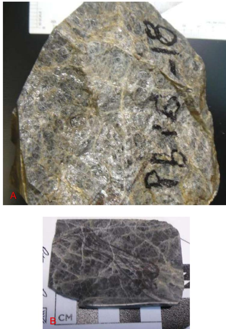
*Fotografía 13. En la muestra de mano (A) **PB16-18** se observa una matriz vítrea con lustre brillante, se aprecia un buen desarrollo de la textura perlítica. En el testigo (B) se aprecian laminaciones opacas contorsionadas.*
