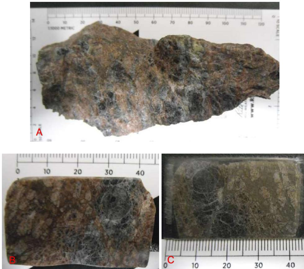
*Fotografía 3. En la muestra de mano (A) **PB16-05** se observa una textura fluidal con fractura concoide, la roca es marrón con porciones grises, en testigo (B) y sección delgada (C) se aprecia una fractura concoide bien desarrollada.*
