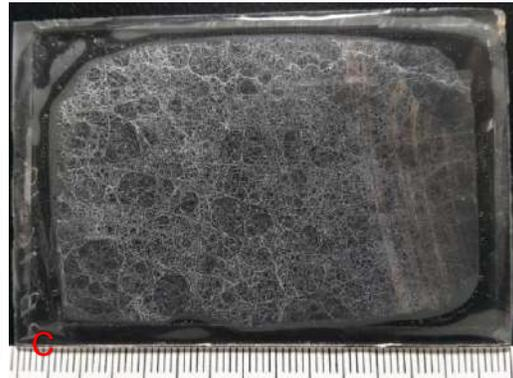
Fotografía 166. En la muestra de mano (A) **PB16-19** es de color gris claro, presenta laminaciones de minerales de óxido de Fe-Ti, (B) en el testigo se aprecia un lustre vítreo, laminaciones fluidales y una fractura concoide, y (C) en sección delgada de observa un buen desarrollo de la textura perlítica..
