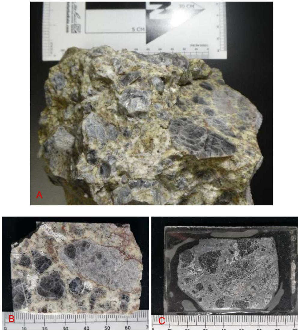
Fotografía 4. En la muestra de mano (A) **PB16-17** se observa una matriz desvitrificada con fragmentos perlíticos, en testigo (B) y sección delgada (C) se observa una matriz fina y fragmentos de pocos centímetros, se observa además una fractura concoide bien desarrollada, y pocas zeolitas.
