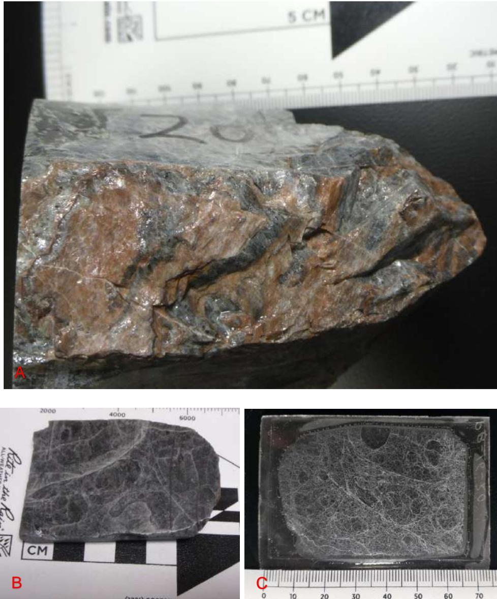
Fotografía 15. En la muestra de mano (A) **PB16-20** se observa una roca vitrea grisácea con rojizo, (B) el testigo muestra presenta un lustre vítreo y (C) en sección delgada se observa un buen desarrollo de la textura perlítica.
