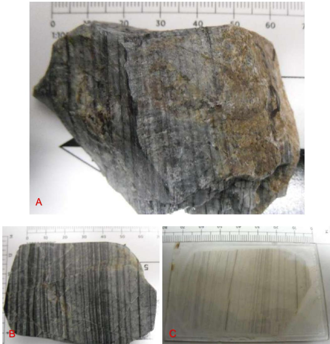
Fotografía 14. En la muestra de mano (A) **PB16-C6A** se observa una matriz vitrea con laminaciones de minerales opacos, en el testigo (B) se observa un lustre brillante, y en sección delgada (C) se observan laminaciones con leves desplazamientos por microfisuras.
