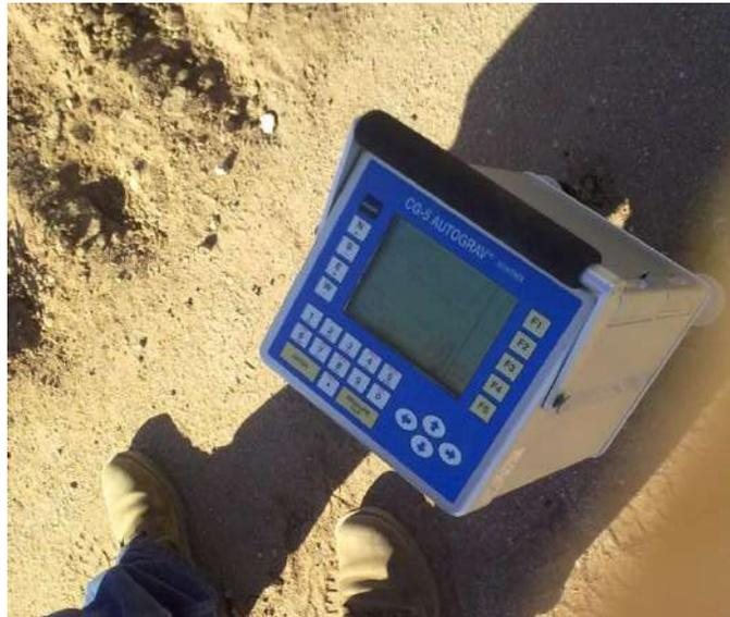
**Fig. 4. 3 Gravímetro Scintrex CG-5**
