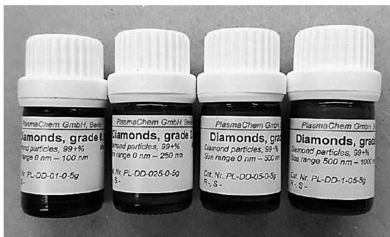
Imagen 1. Nanodiamantes sintetizados por la técnica de detonación de explosivos usados en el presente trabajo de investigación.
