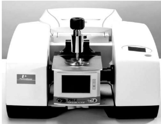
Imagen 9. Equipo equipo Perkin Elmer Frontier FT-IR/FIR Spectroscopy y en el centro un accesorio GladiATR Pike que permite trabajar con materiales inorgánicos y brinda un amplio rango espectral, desde MIR hasta el FIR. Tomado de [47].
